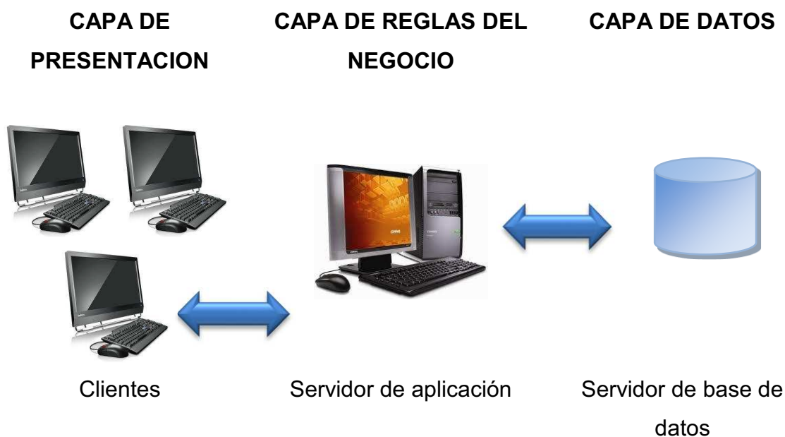
Figura 2.49: Arquitectura del Sistema
