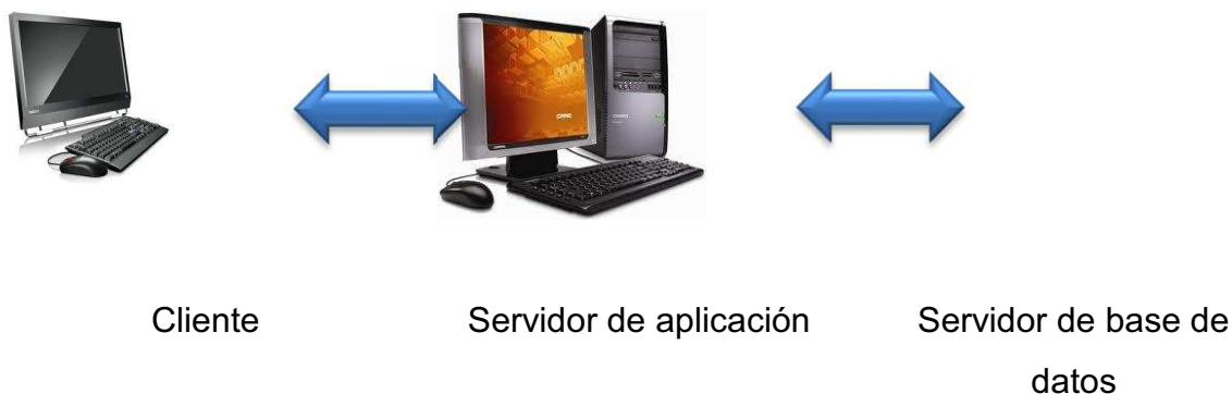
Figura 1.3: Arquitectura de tres capas
