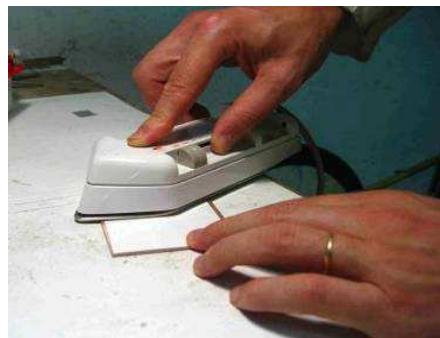
Fig. 2.8 Fijado del circuito mediante la transmisión de calor en la baquelita.
