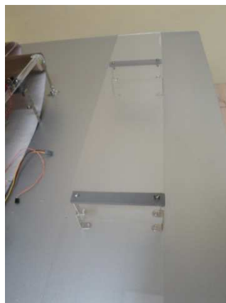
Fig. 2.62 Estructura de soporte para la banda transportadora.
