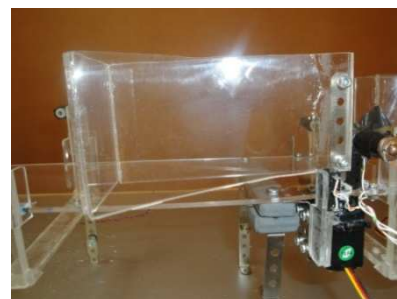
Fig. 2.42 Compuerta ubicada sobre el soporte del motor.
