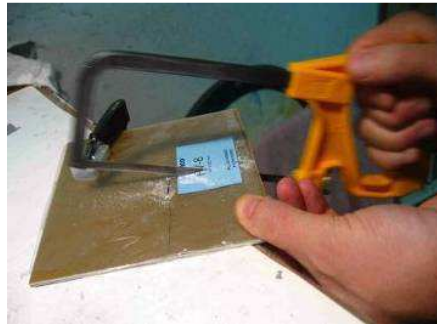
Fig. 2.7 Cortado de la baquelita según el tamaño del circuito.
