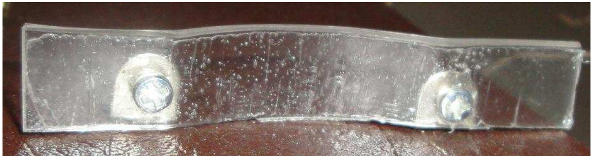
Fig. 2.78 Colector sobre la banda elevadora.
