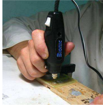
Fig. 2.16 Perforado de la placa.
