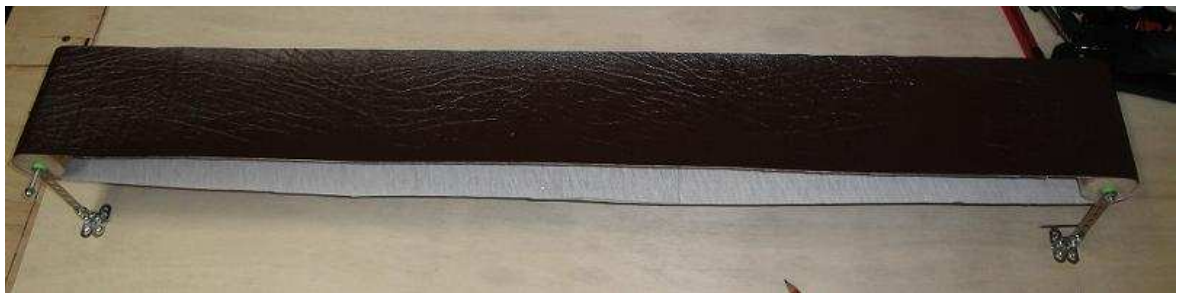
Fig. 2.53 Prueba de tensión de la banda transportadora principal.
