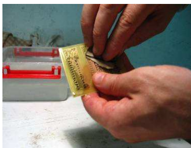
Fig. 2.14 Lijado de la placa.
