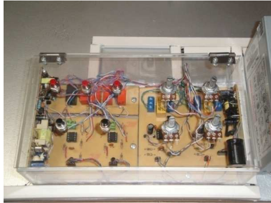
Fig. 2.107 Ubicación de los diferentes elementos de control sobre la tapa de la caja de acrílico.
