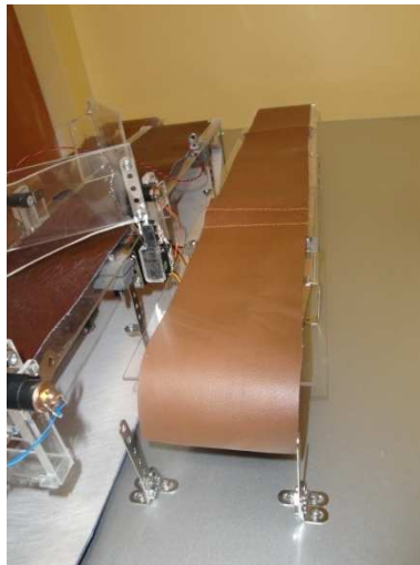
Fig. 2.65 Banda transportadora y soportes del rodillo.
