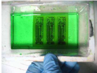
Fig. 2.12 Cobre removido de la placa.
