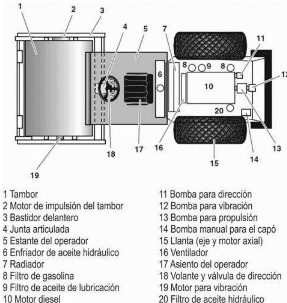
Figura D.79. Partes principales de un compactador vibratorio de tambor simple 103
