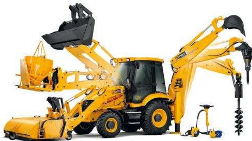
Figura D.87. Retroexcavadora con diferentes elementos de trabajo. 114
