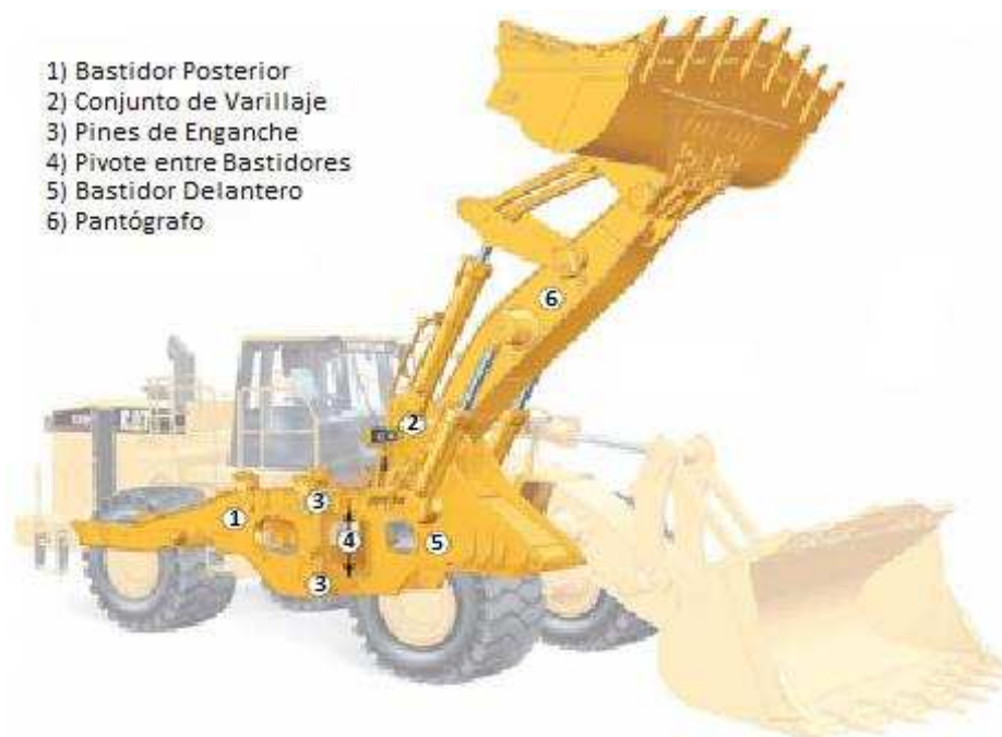
Figura D.55. Partes del Bastidor Cargador Frontal 74
