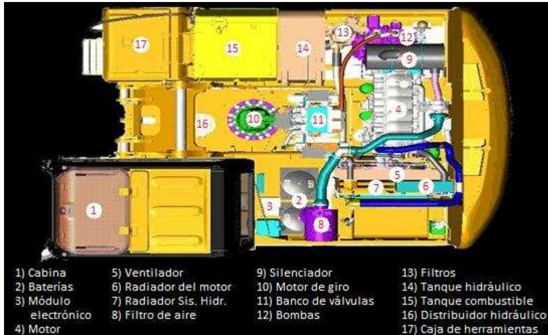
Figura D.66. Partes del Tren de potencia y Sistema Hidráulico 87
