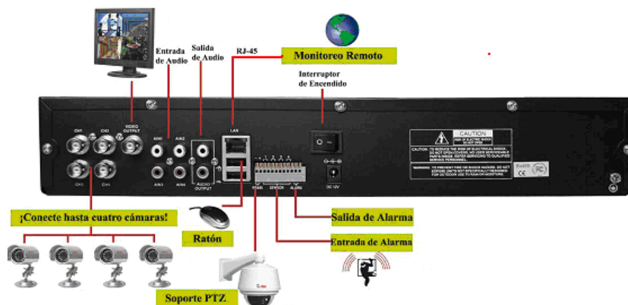
Figura 1. 9 Canales de entradas y salidas que dispone un DVR de cuatro cámaras [12].
