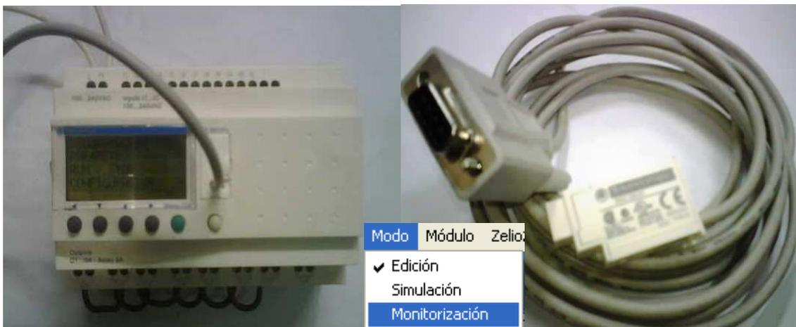
**Figura 4.11 PLC conectado a la PC mediante cable de datos.**
