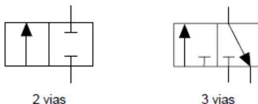
**Figura 3.14 Representación gráfica de una válvula 2/2 (2 vías, 2 posiciones) y una 3/2(3 vías, 2 posiciones).**
