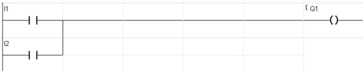
**Figura 2.12 Ejemplo gráfico de activación con dos switchs paralelo.**
