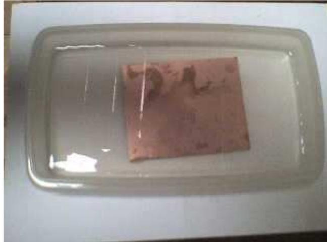
. Introduzca la placa virgen en la solución acida, si el ácido ya ha sido utilizado varias veces y tiene poca acción, introduzca el calentador para peceras.
