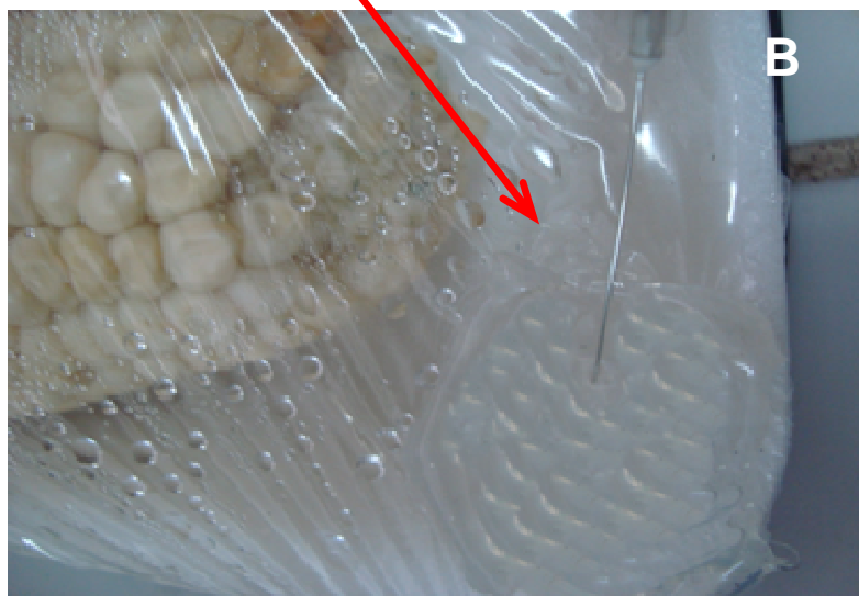
Figura 32. Sistema de respiración (A); Séptum de silicona en el empaque (B)
