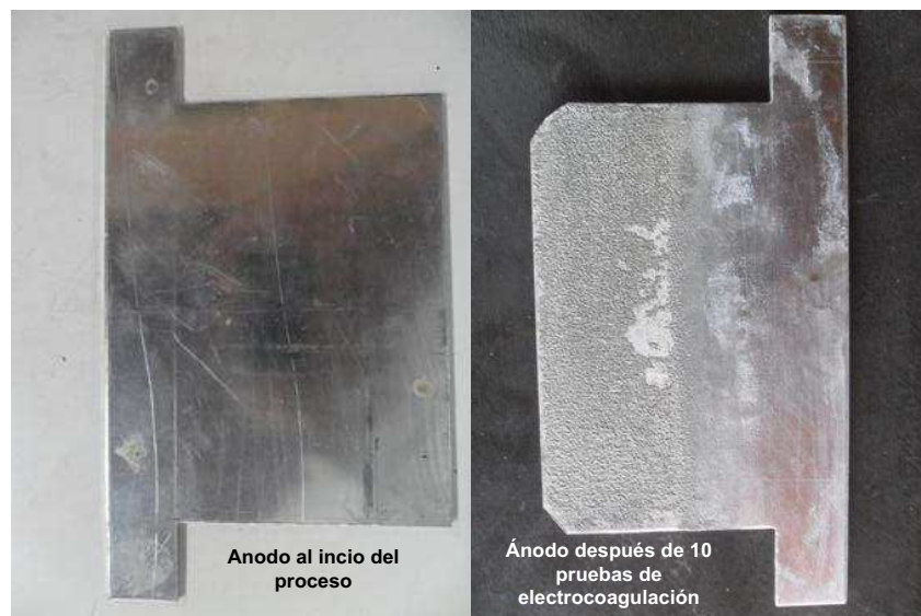
Figura 3.4. Formación de una capa de óxidos sobre el ánodo
