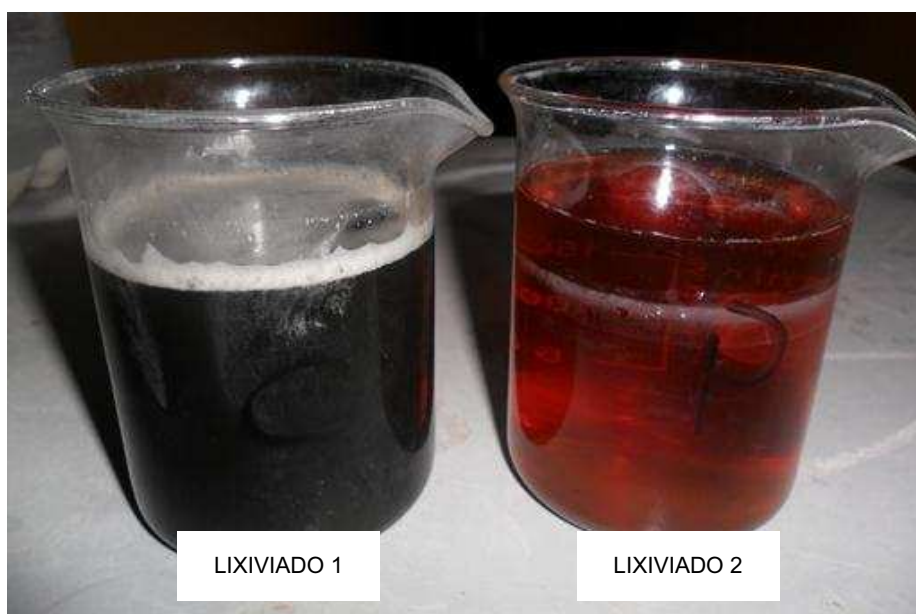
Figura 3.1. Lixiviados generados en el relleno sanitario El Inga
