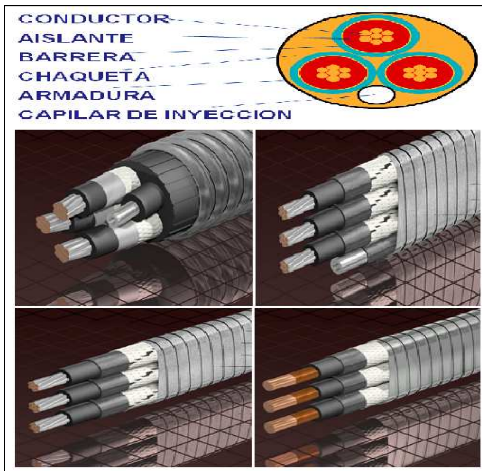
Figura 1.15 ESTRUCTURA Y TIPOS DE CABLES DE POTENCIA
