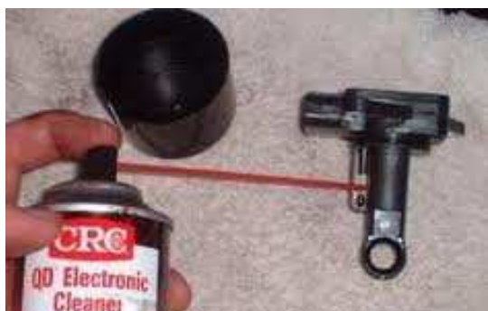
Figura 5.30. Limpieza del IAT y MAF con espray dieléctrico 38
