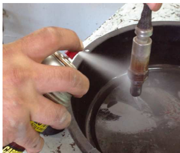
Figura 5.29: Limpieza de la sonda lambda con espray dieléctrico. 37
