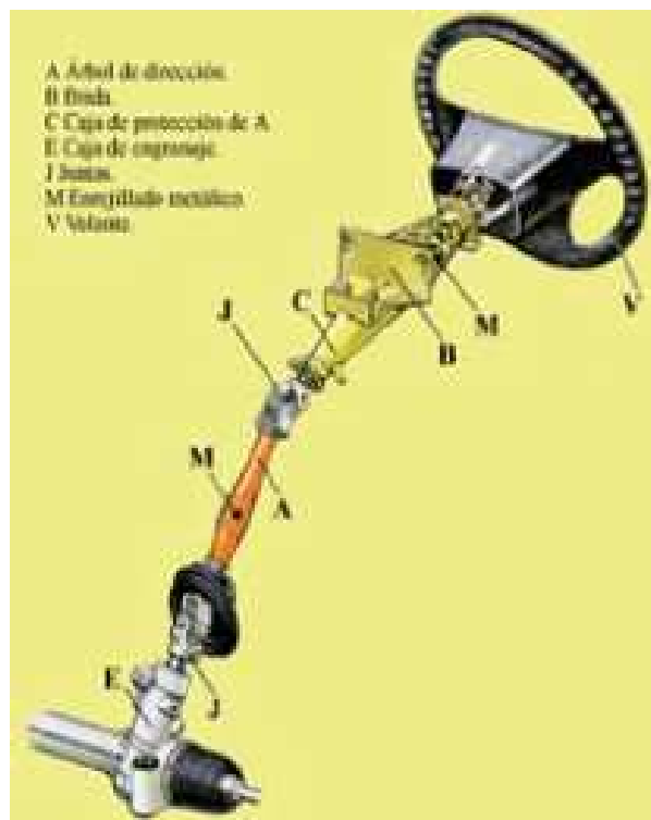
Figura 3.19: Volante y caja de dirección
