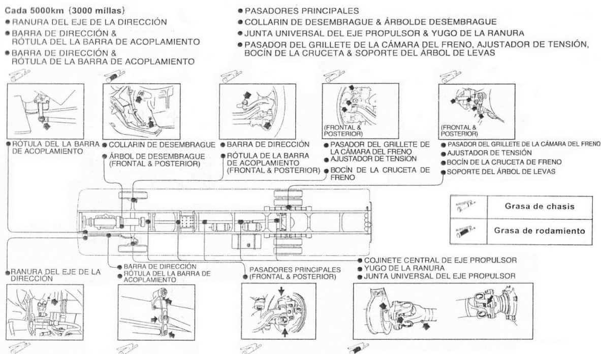
Figura 5.1: Puntos de engrase en el chasis
