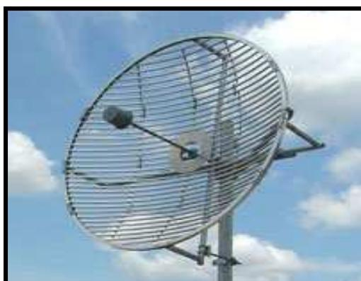
**Figura 3.36: Antena Parabólica Grilla.**
