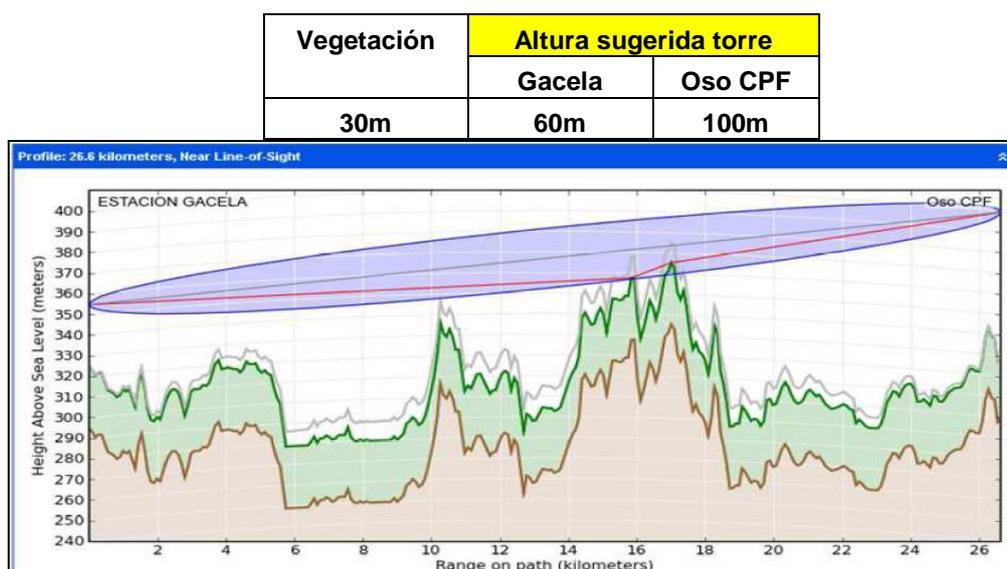
Figura 3.15: Perfil del enlace Gacela – Oso CPF.
