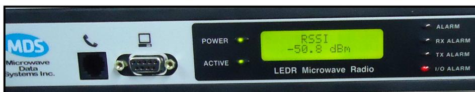
Figura 3.60: Nivel de señal en el display del Radio MDS.
