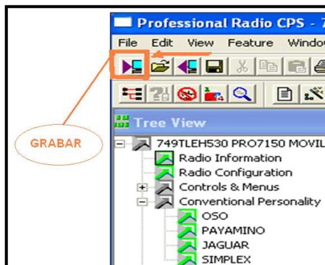
Figura 2.17: Paso final para la programación de las Radios Motorola.
