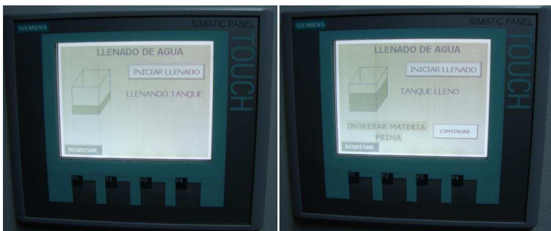
Figura 4.3.a. Ingreso de agua a la olla tintura. Figura 4.3.b. El sensor detecta el nivel alto
