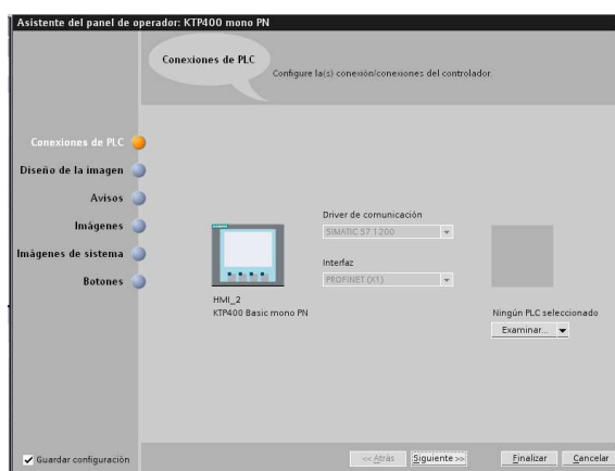
Figura 3.15 Conexión entre la pantalla táctil y el PLC.
