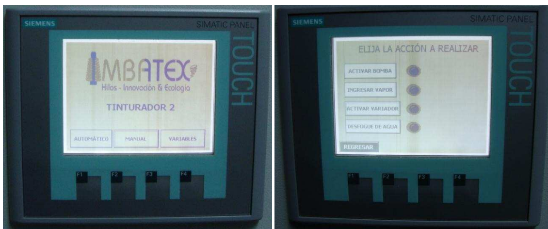
Figura 4.1.a. Selección modo manual Figura 4.1.b. Activar/Desactivar dispositivo
