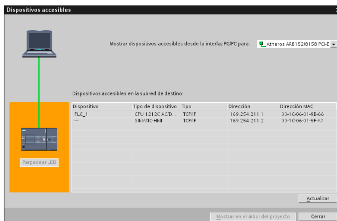
Figura 3.18a Conexión On line.
