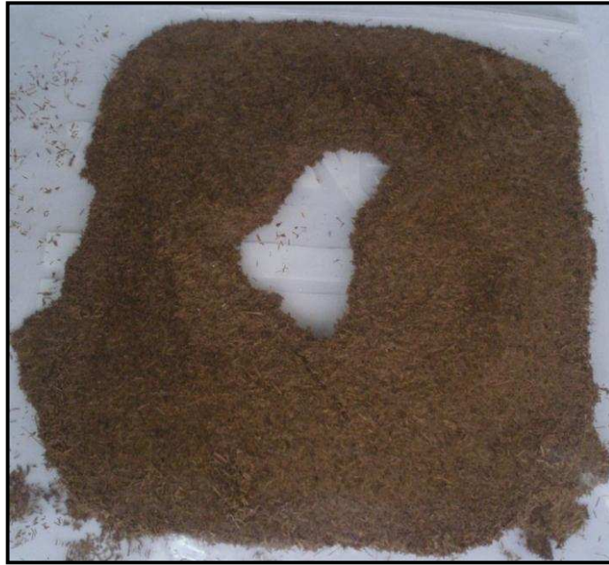
Figura 46.10 Tablero obtenido en pruebas preliminares con fibra retenida en malla # 40, densidad de 0,6 \text{ g/cm}^3 , humedad del 4 % a 220 \text{ }^\circ\text{C} , 14 MPa de presión y tiempo de 3 min, catalogado como malo
