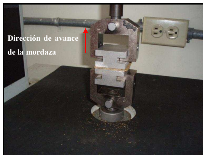
Figura 45.8 Ensayo de tracción perpendicular a la superficie con los aglomerados elaborados
