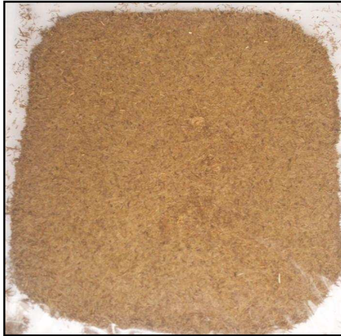
Figura 46.9 Tablero obtenido en pruebas preliminares con fibra retenida en malla # 40, densidad de 0,6 \text{ g/cm}^3 , humedad del 4 % a 160 \text{ }^\circ\text{C} , 14 MPa de presión y tiempo de 3 min, catalogado como bueno
