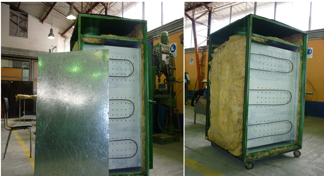
Figura 3.17 Conformación de las paredes aislantes
