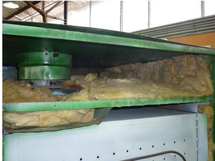
Figura 3.22 Dispositivo de aire forzado, con su respectiva capa de aislamiento
