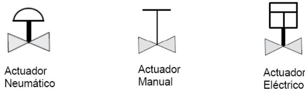
Figura 1.5. Válvulas con sus respectivos tipos de actuador.
