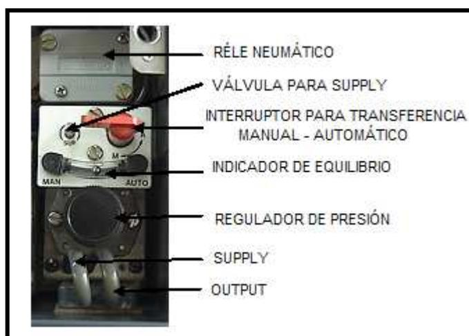
Figura 5.9. Sistema de transferencia manual – automático del P.I.C.
