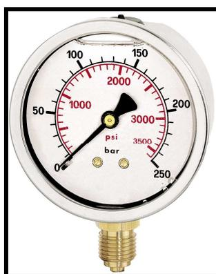
Figura 2.2. Manómetro tipo bourdon
