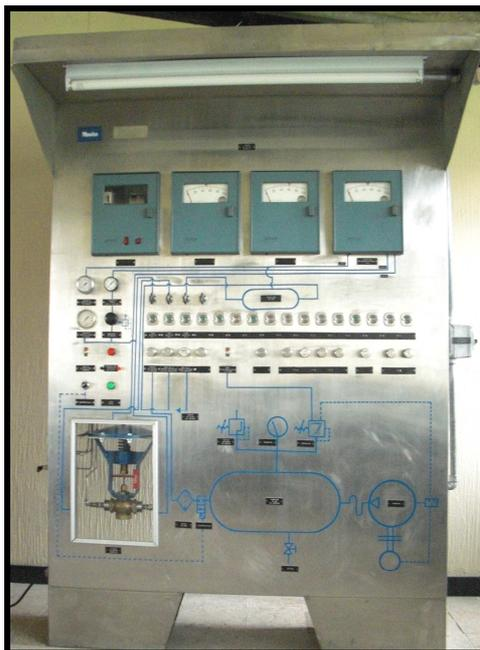
Figura 4.1. Estructura metálica del módulo didáctico de control neumático.
