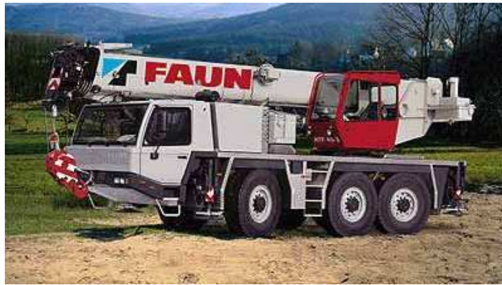
Figura 1.9 Grúa montada sobre un camión.
