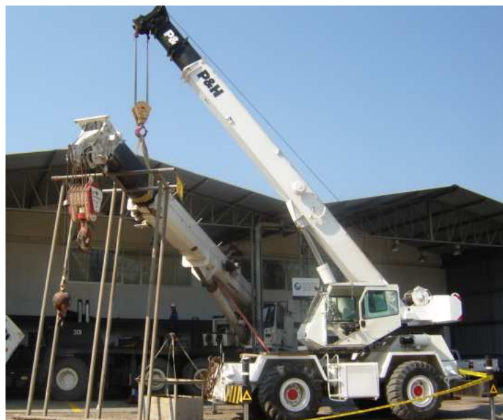
Figura 1.10 Grúa Industrial móvil.
