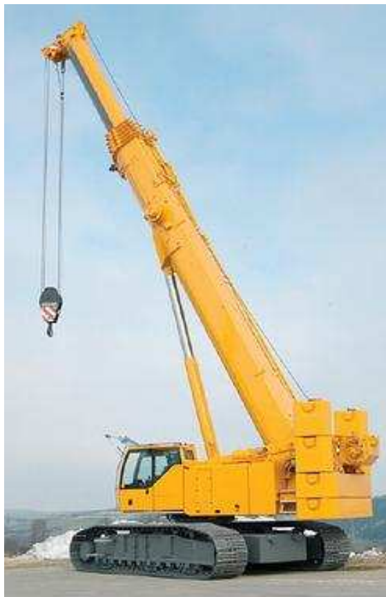
Figura 1.11 Grúa montada sobre una oruga.
