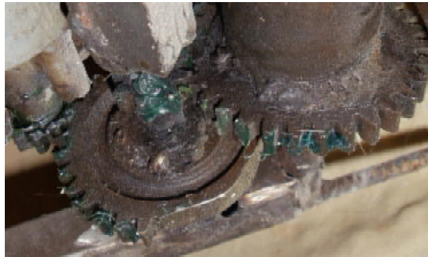
Figura 1.3 Lubricación de engranajes expuestos a la intemperie o abiertos
