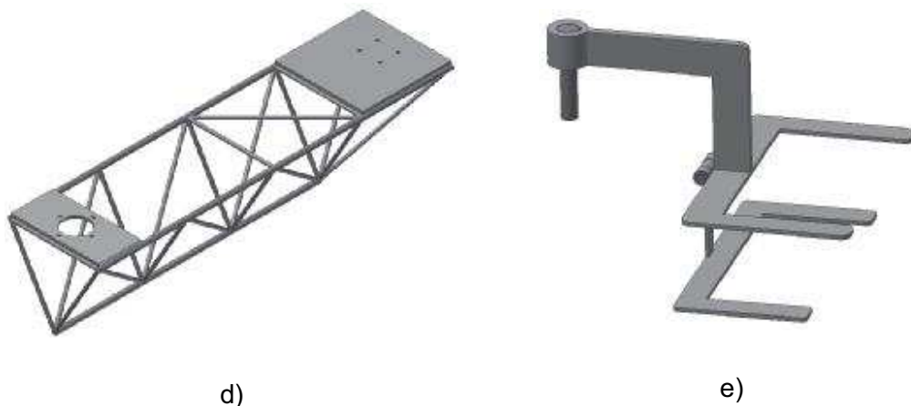
Figura 5.1 a) placa base, b) estructura tórax, c) mecanismo del cuello, d) estructura del cuello y e) mecanismo de la cabeza
