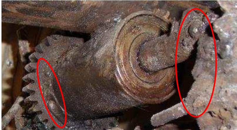
Figura 1.5 Soldadura mecanismo de engranes
