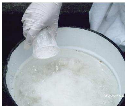
f. Adición del hidróxido de calcio
