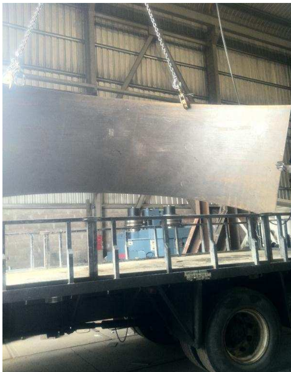
Figura 3. 21 – Traslado de planchas roladas.
