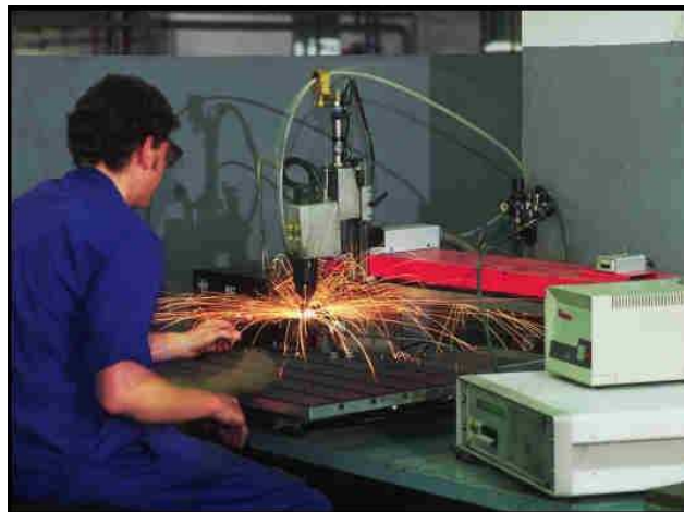
Figura 1. 10 – Proceso de soldadura por resistencia.
