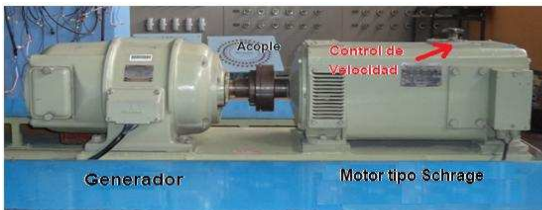
Figura 4.5 Grupo Motor-Generador de la Mesa 4 del Laboratorio de Máquinas Eléctricas de la FIEE
