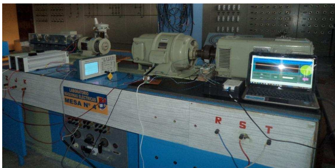
Figura 4.6 Implementación del circuito medidor de ángulo de potencia
