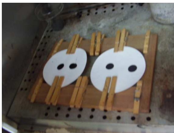
Figura AIV.5. Esquema del soporte utilizado para las pruebas de estabilidad y compatibilidad
