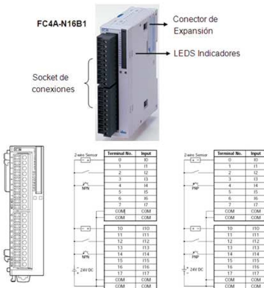
Figura 3.5 - Módulo DC in de 16 entradas y diagrama de conexiones.
