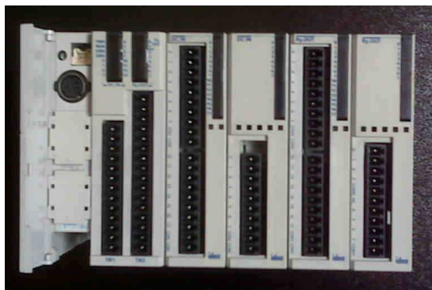
Figura 2.8 - PLC MicroSmart FC4A-D20RK1 y módulos de ampliación.
