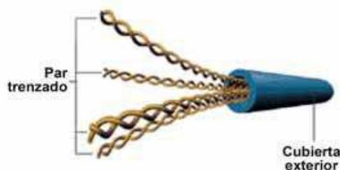
Figura 2.2 Cable Par Trenzado<sup>8</sup>
