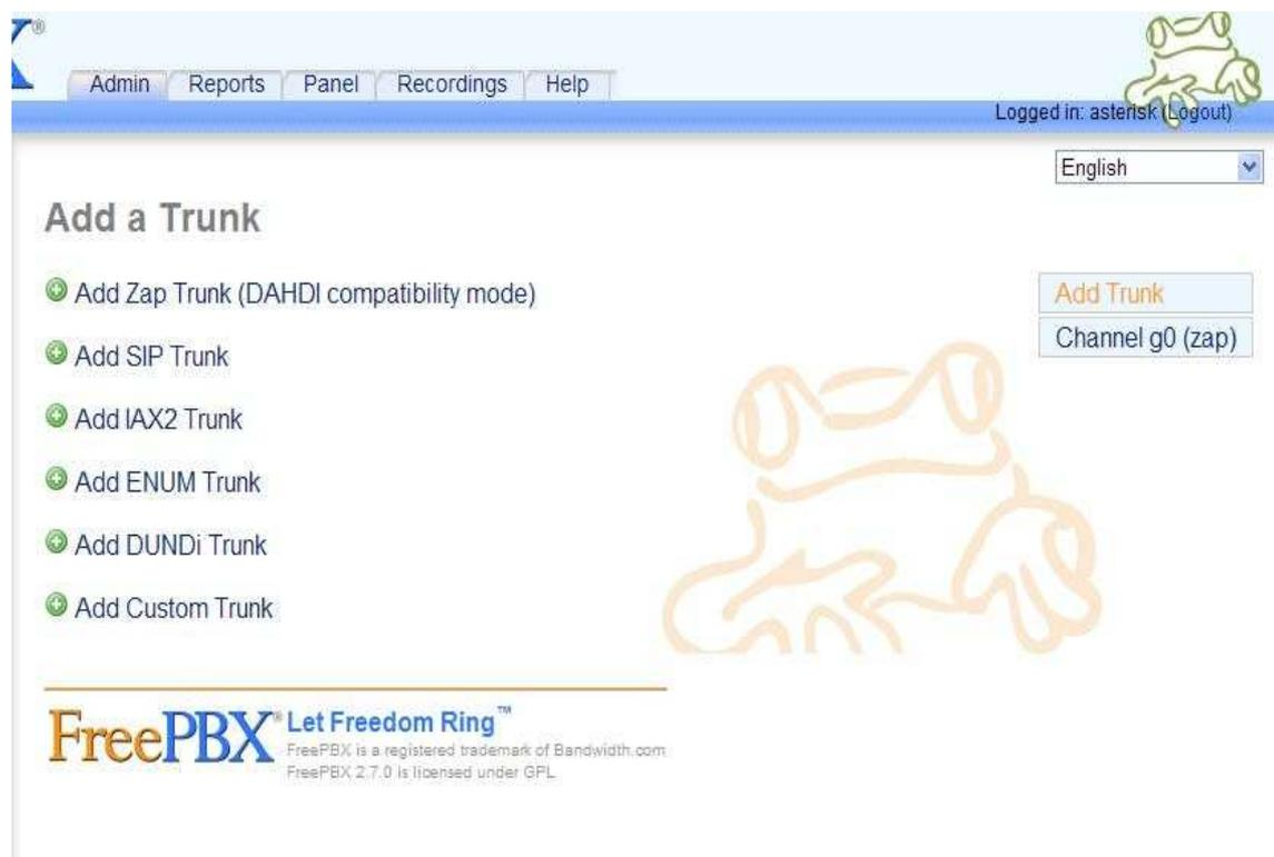
Figura 5.21 Configuración de la Troncal
