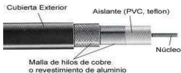
Figura 2.1 Cable Coaxial<sup>6</sup>
