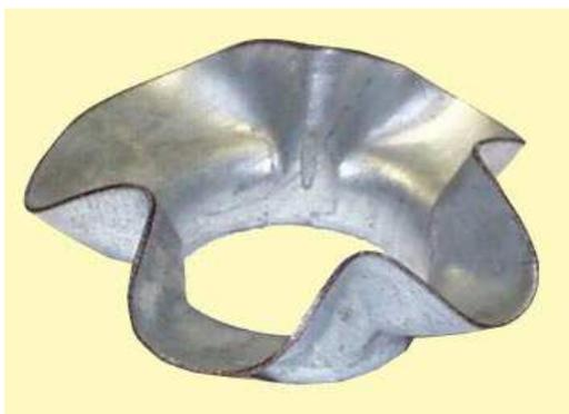
**Figura 1. 15** Pieza embutida desgarrada en el fondo.<sup>28</sup>
