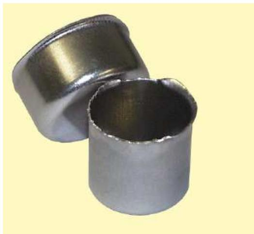
**Figura 1. 18** Formación de un labio en el borde de una pieza embutida.<sup>31</sup>
