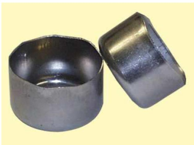
**Figura 1. 17** Pieza con sinuosidades en el borde de embutición.<sup>30</sup>
