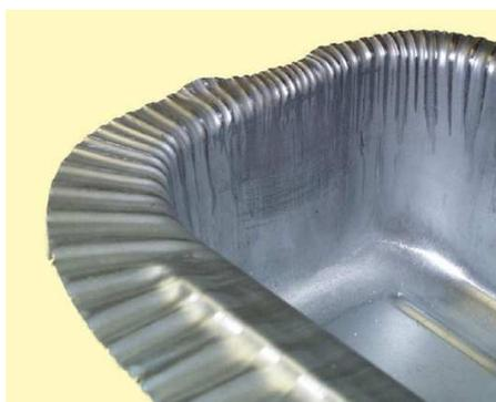
**Figura 1. 11** Formación de arrugas en una pieza embutida.<sup>24</sup>
