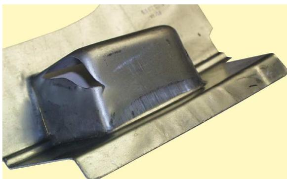
**Figura 1. 12** Rotura originada por una gradación de embutición demasiado grande.<sup>25</sup>
