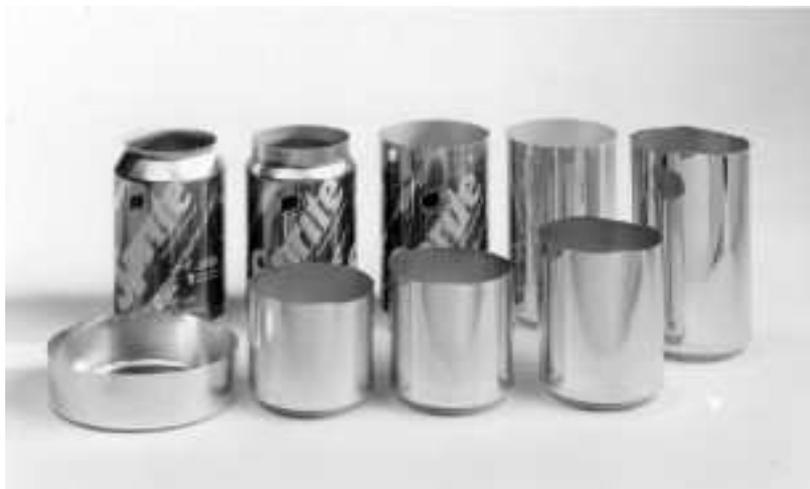
**Figura 4.1** Etapas de formado para la obtención de un envase para bebidas.<sup>55</sup>
