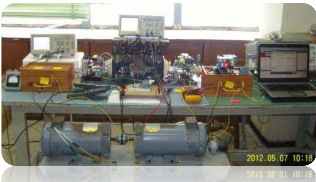
Figura 4.22 Prueba como convertidor dual con control de corriente circulante
