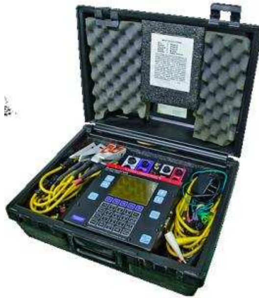
Figura 4.37 Analizador de potencia Powermate™ 330
