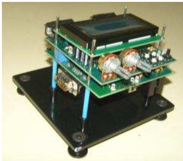
Figura 2.50 Módulo de control de corriente circulante e interfaz con el usuario
