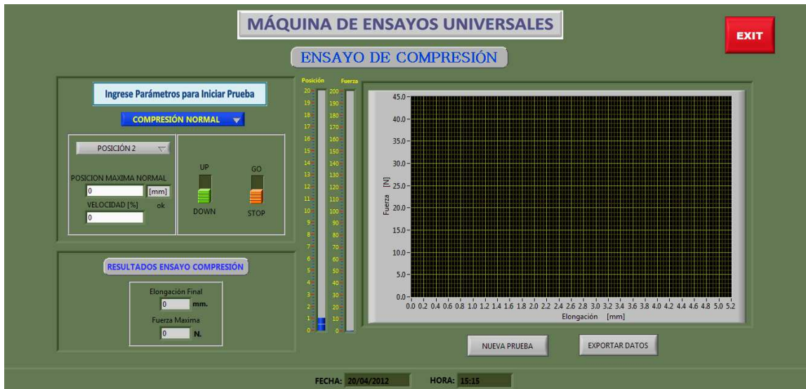
Figura 4. 31 Pantalla del Ensayo de Compresión
