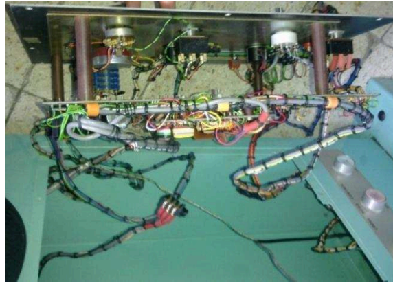
Figura 1. 18 Estado Inicial de la Máquina de Ensayos Universales - Panel Frontal;
