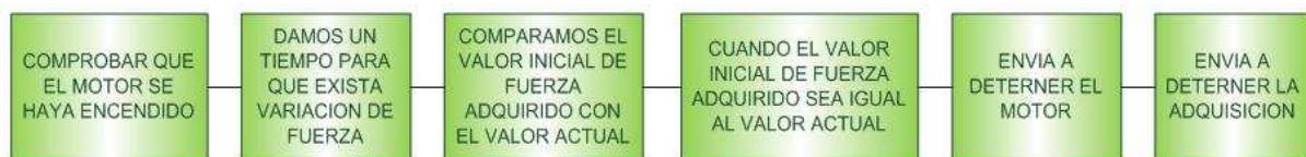
Figura 3. 39 Diagrama de Bloques para detectar que el hilo se rompió
