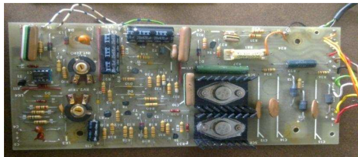
Figura 1. 22 Estado Inicial de la Máquina de Ensayos Universales - Control de velocidad del motor
