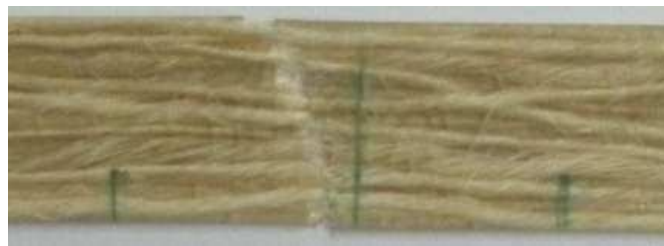
(b) Fractura enteramente de la matriz. Las fibras se fracturan parcialmente.
