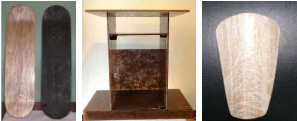
Figura 1.7. Compuestos reforzados con fibras naturales: (a) poliéster-abacá-fibra de vidrio; (b) poliéster-coco-fibra de vidrio; (c) polipropileno-abacá-fibra de vidrio. [13] [27] [30]
