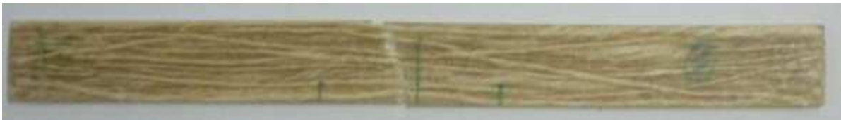
(a) Fractura frágil de la matriz sin producirse una reducción de la sección de la probeta.
