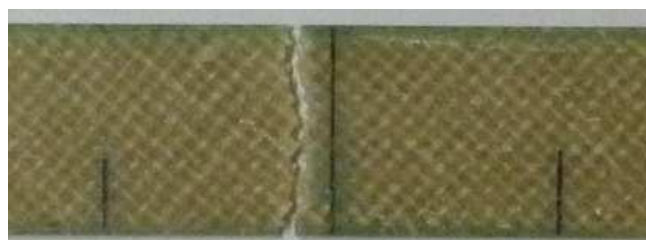
(c) Tanto la matriz como las fibras se fracturan.
