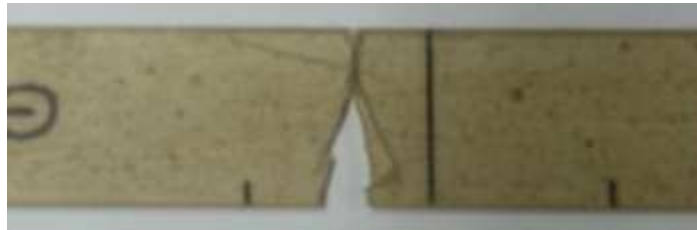
(a) Fractura frágil de la matriz sin producirse una reducción de la sección de la probeta.
