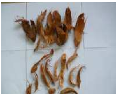
Figura 3.37. Comparación de los anchos de cáscara que ingresa a la trituradora, parte superior cáscaras de 5-6 cm, parte inferior cáscaras de 2-3cm. [27]
