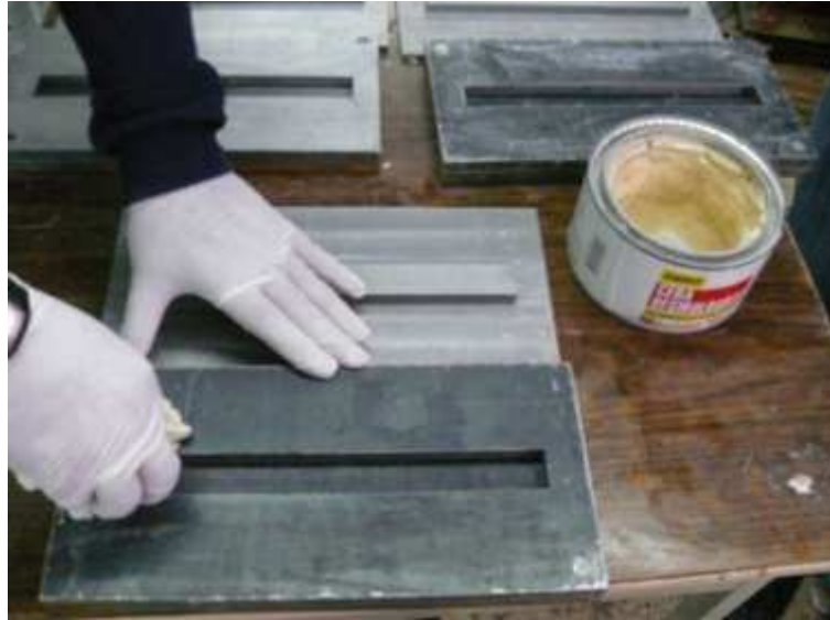
Figura 2.26. Aplicación de cera desmoldante.
