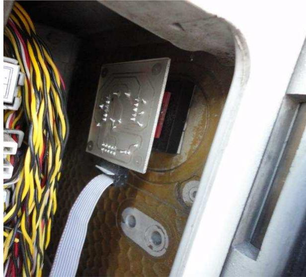
**Figura 4.6:** Placa externa del lector RFID colocado en el extremo superior del armario.
