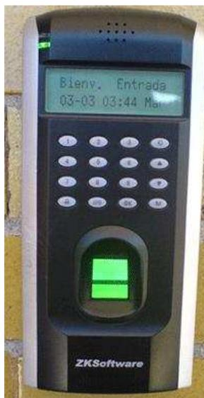
**Figura 1.1:** Sistema Biométrico basado en huellas dactilares <sup>[10]</sup>
