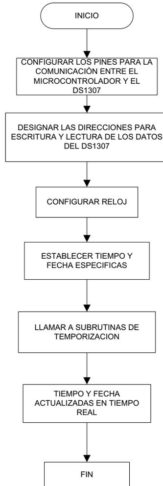
**Figura 3.2:** Diagrama de flujo de la configuración para el reloj en tiempo real DS1307
