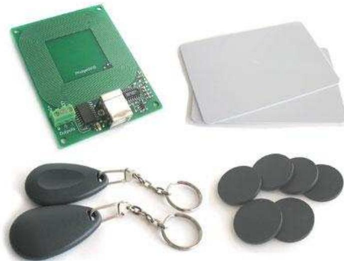
**Figura 1.7:** Diversos tipos de tags RFID <sup>[2]</sup>
