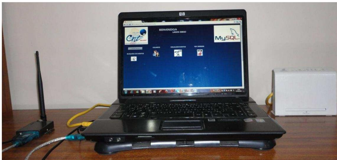
**Figura 4.12:** Computador que actúa como servidor, junto con los módems respectivos para la conexión a internet y red GSM.
