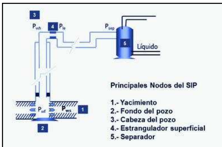
FIGURA 2.1 ESQUEMA DE PRODUCCION DE CRUDO
