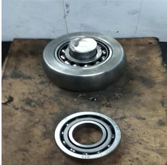
**Fotografía. Montaje de rodamientos en matriz móvil.**
