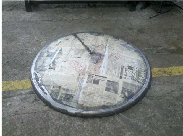
**Fotografía 4.8.**Fondo Toriesférico (Acero Inoxidable de 3mm de espesor).
