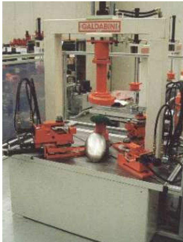
**Figura 1.15.** Rebordeadora hidráulica
