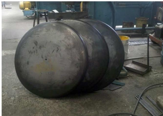
**Fotografía 4.7.**Fondo Toriesférico (Tol negro de 5mm de espesor).
