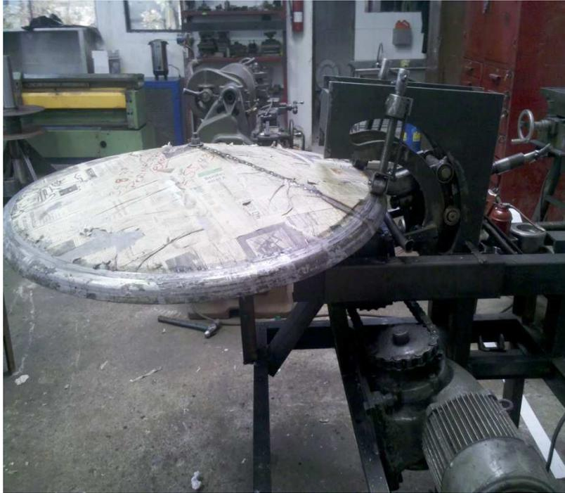
**Fotografía. Proceso de rebordeado (acero de 4mm).**
