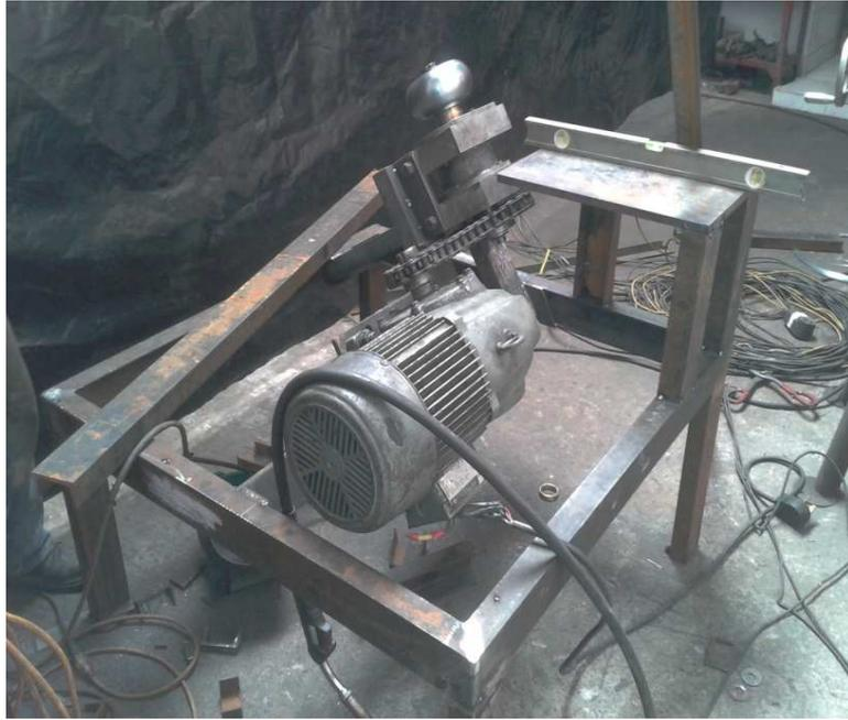
**Fotografía 4.3.** Montaje del motor a la estructura.
