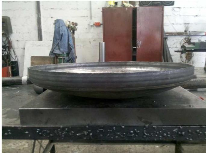
**Fotografía 4.6.**Fondo Toriesférico (Acero galvanizado de 4mm de espesor).
