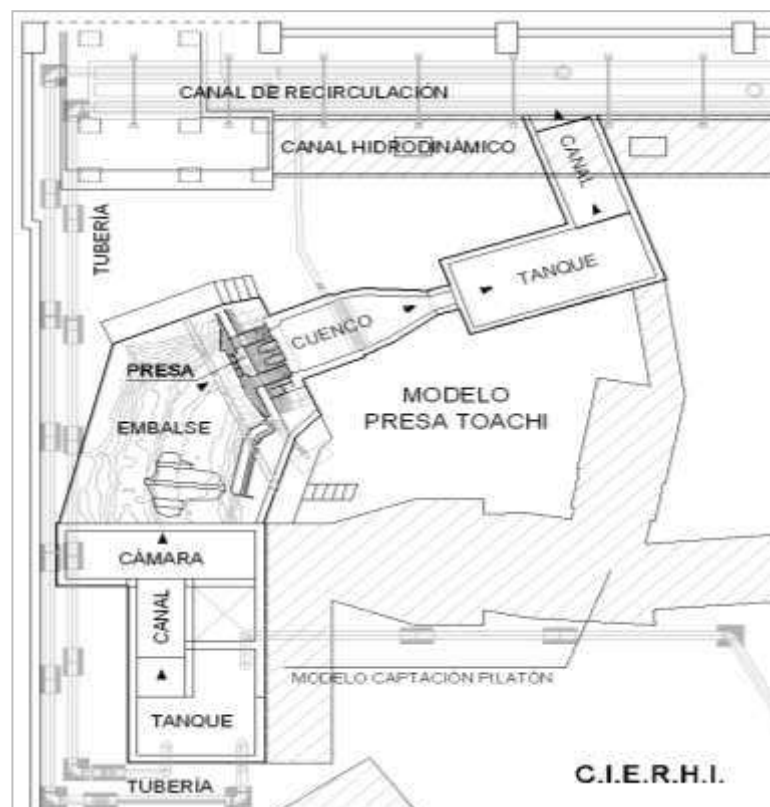
Figura No. 4.1: Implantación general del modelo en el C.I.E.R.H.I.
