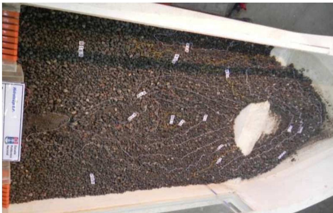
Fotografía No. 6.4: Vista en planta desde aguas arriba de la configuración del cuenco con operación del desagüe de fondo derecho con caudal 575.09 \text{ m}^3/\text{s}
