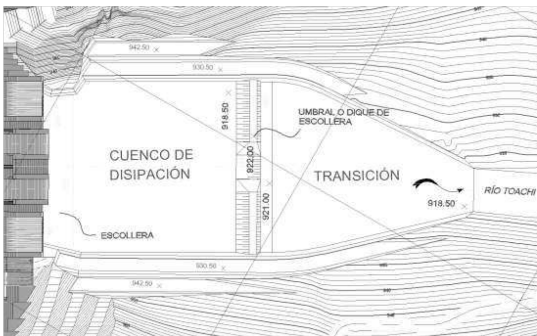
Figura No. 1.9: Vista en planta - Cuenco de disipación - Presa Toachi
