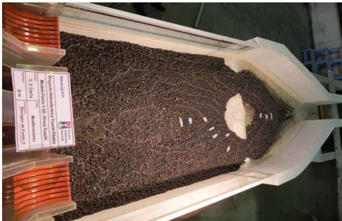
Fotografía No. 6.3: Vista en planta desde aguas arriba de la configuración del cuenco con operación del desagüe de fondo derecho con caudal 533.13 \text{ m}^3/\text{s}
