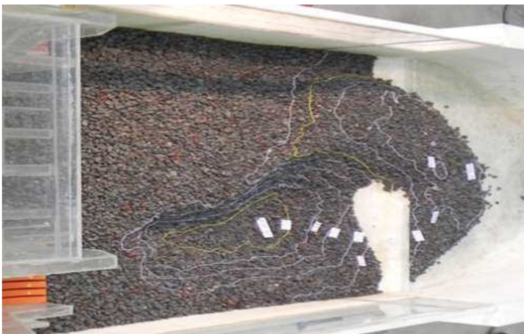
Fotografía No. 6.12: Vista en planta desde aguas arriba de la configuración del cuenco con operación del vertedero de excesos derecho con caudal 594.85 \text{ m}^3/\text{s}
