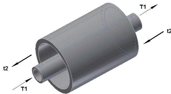
FIGURA 1. 3 Esquema de un intercambiador de calor primitivo (T1; fluido frío, t2 fluido caliente)
