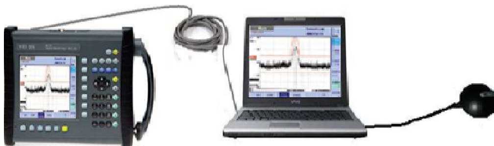
FIGURA 2.57 Conexión entre el computador, el analizador y la antena
