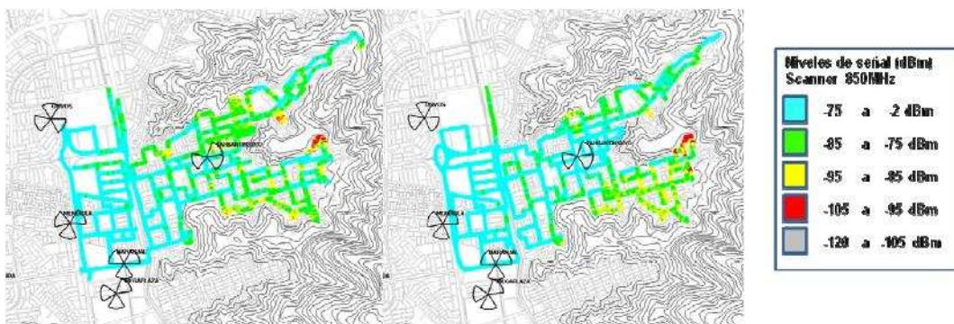
FIGURA 1.11 Presentación de un drive test antes y después de instalar una BTS 22
