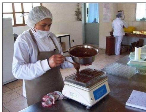
**Figura 3.17.** - Colocación del chocolate temperado en el molde
