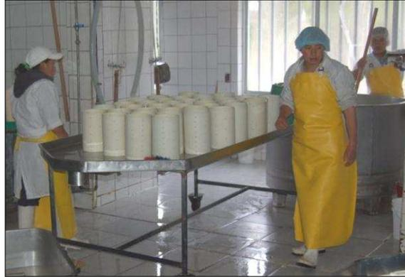
**Figura 3.29.** - Tratamiento de la cuajada, moldeo y prensado
