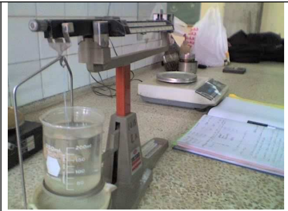
Medición del peso en inmersión de una probeta de piedra pómez
