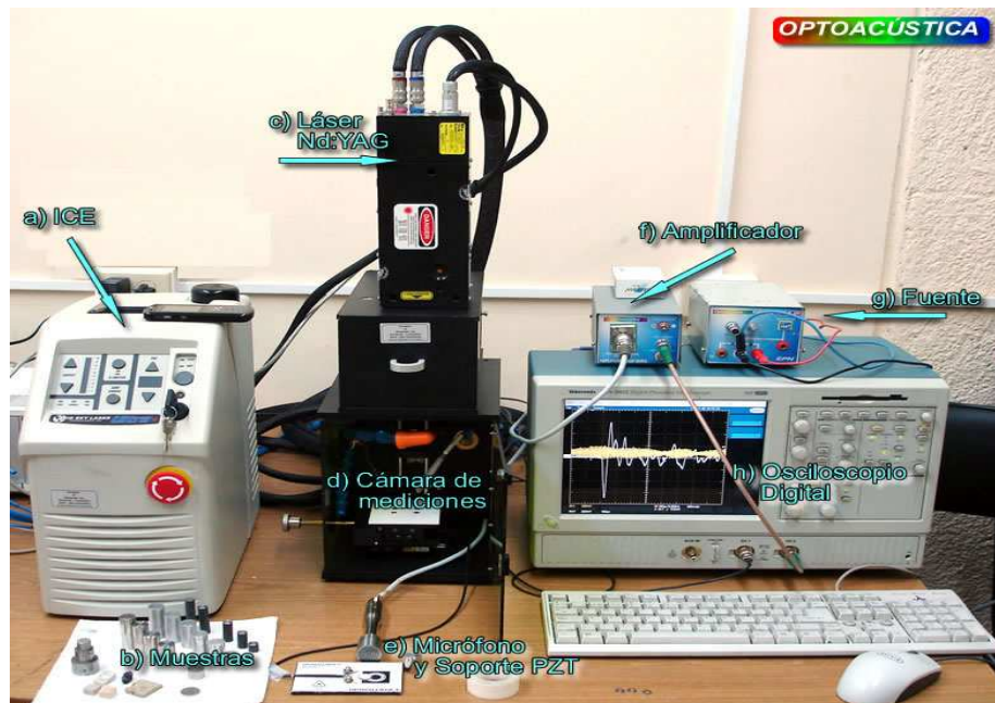
Figura 3-1. Mesa de Trabajo, a) ICE, b) muestras, c) láser, d) cámara de mediciones, e) micrófono y soporte PZT, f) amplificador, g) fuente, h) osciloscopio digital.
