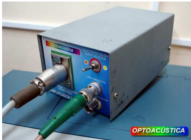
Figura 3-10. Amplificador AMPACR06 , alimenta el preamplificador del micrófono y amplifica su señal.
