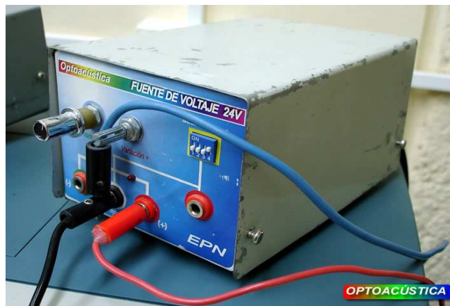
Figura 3-9. Fuente de alimentación variable con salida adicional regulada para suplir la energía necesaria y polarizar el preamplificador y el amplificador.
