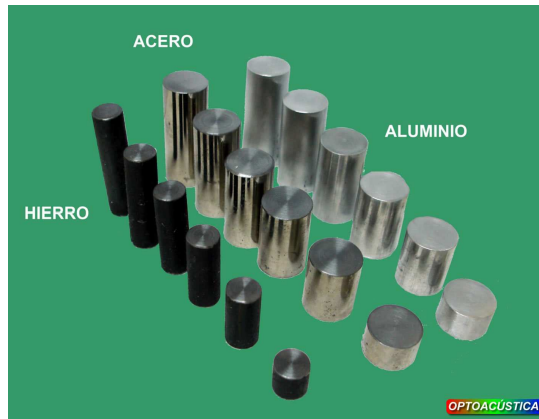
Figura 3-16. Probetas de Hierro, Aluminio y Acero de dimensiones que van desde 40 [mm] hasta 10 [mm].
