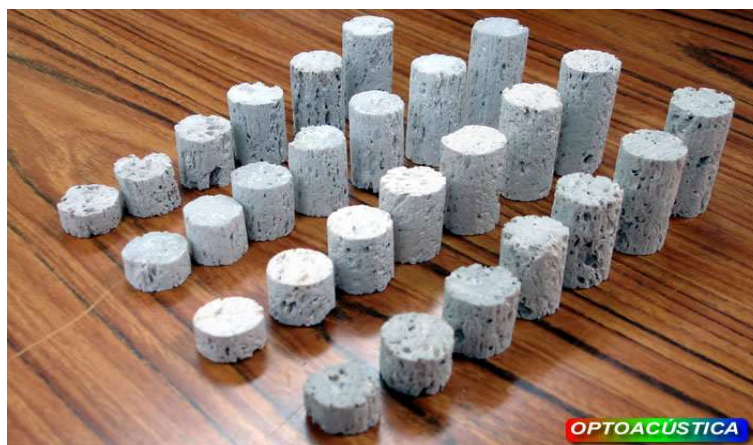
Figura 3-18. Cuatro grupos de probetas de tipos diferentes de piedra pómez.
