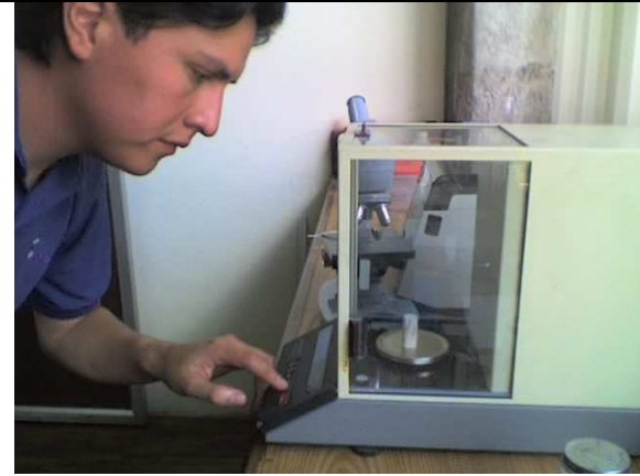
Probeta de piedra pómez pesándose en una balanza analítica.
