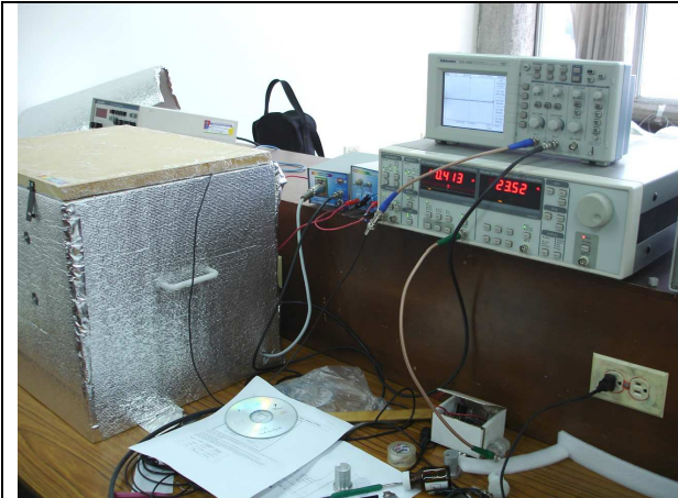
Sistema optoacústico utilizando el láser continuo modulado utilizando el Lock In.
