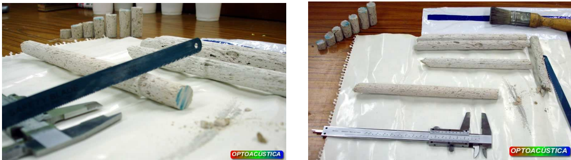
Figura 3-17. Preparación de probetas de piedra pómez a partir de barras longitudinales para mantener una direccionalidad en los poros de la roca.
