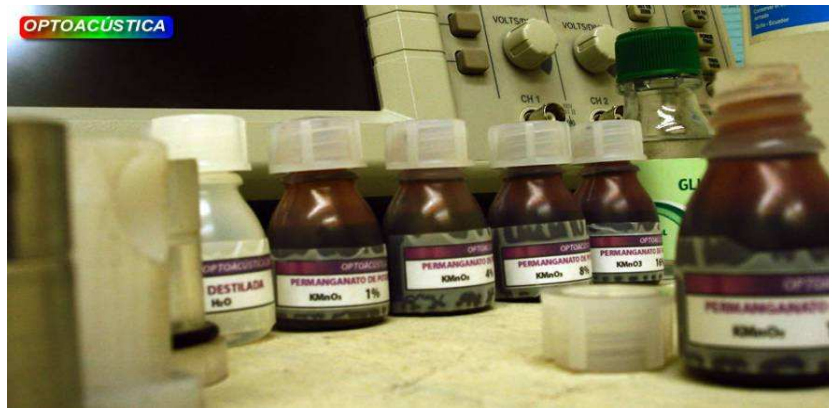
Figura 3-19. Muestras líquidas de \text{KMnO}_4 en diferentes concentraciones, alcohol y glicerina
