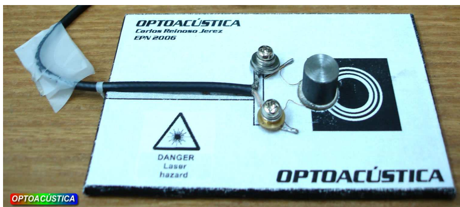
Figura 3-14. Soporte para PZT, con una muestra de Hierro sobre el sensor. El sensor es la pastilla circular en la base del cilindro de hierro, y apenas sobresale a los bordes de este. La pastilla sobresale la superficie de la placa de soporte para asegurar un contacto adecuado con la muestra.
