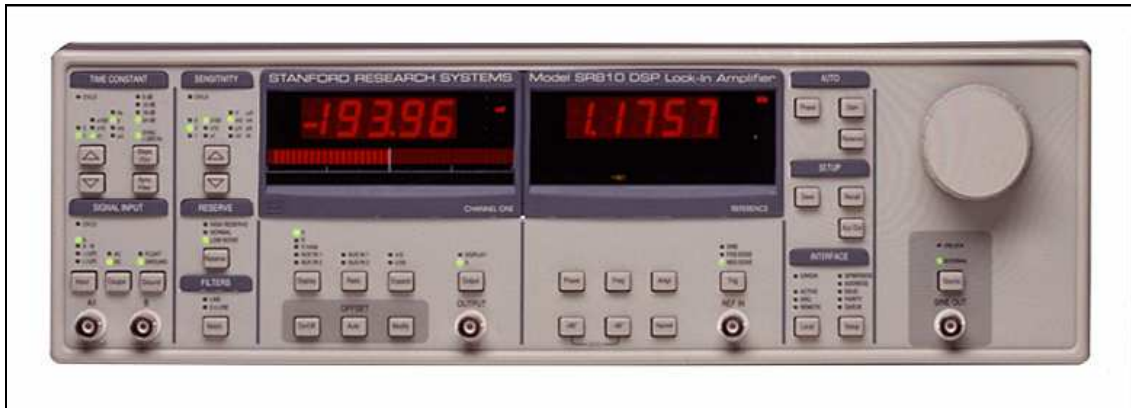
Figura 3-27. Imagen del panel frontal del Lock In SR810 (imagen tomada del Manual del Lock In SR810 [7]).
