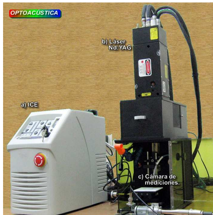
Figura 3-2. a) Integrated Cooler and Electronics (ICE), b) Láser Nd:YAG y c) cámara de medición.
