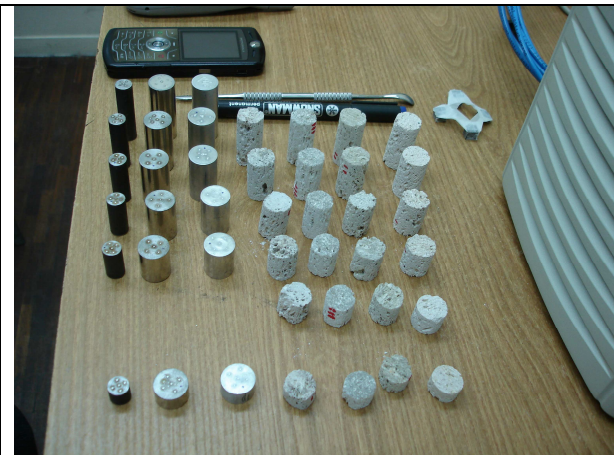
Muestras de piedra pómez listas para entrar en el proceso de medición.
