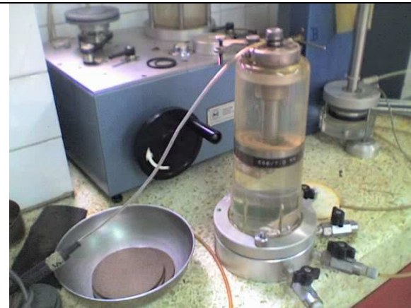
Probetas de piedra pómez dentro de la cámara de compresión con H_2O a una presión de 30[KPa]
