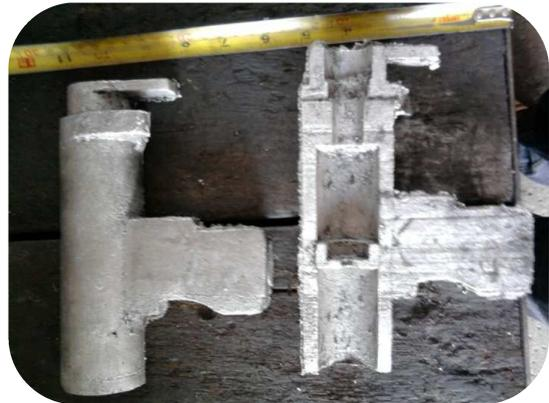
Fotografías de la carcasa construida por fundición.
