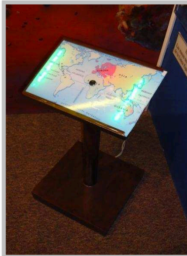
Figura 4. 3 Muestran los pedestales, en la parte superior se encuentra los dispositivos esclavos que toman los datos del sistema
