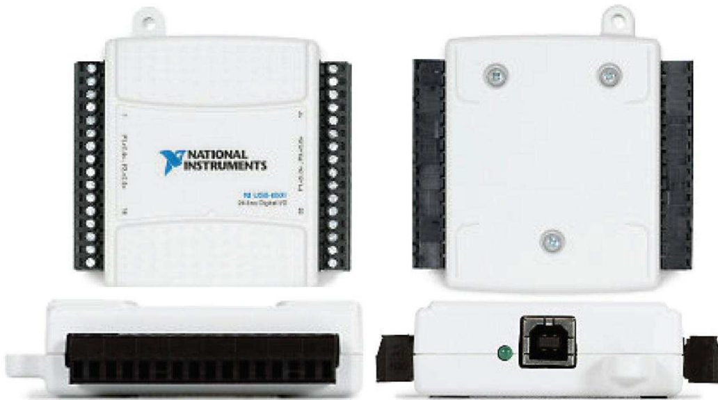
Figura 2.5 Tarjeta de adquisición de datos NI USB-6501, tomado de [7]
