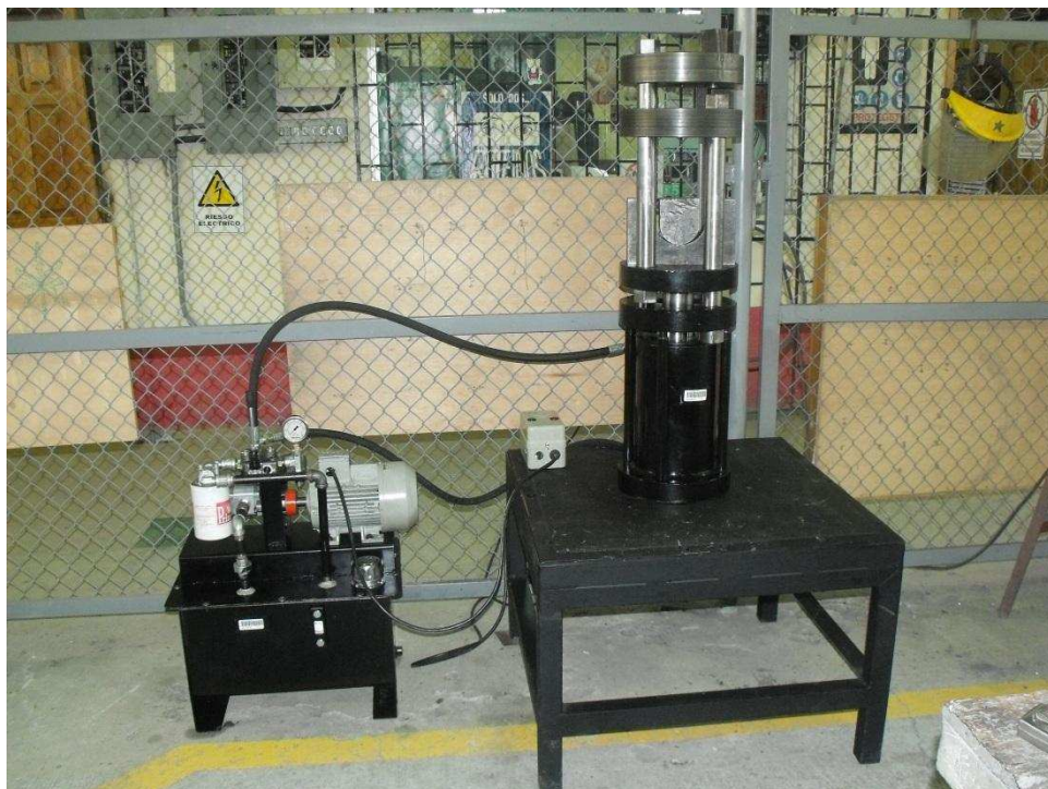
Figura 5-8: Máquina de ensayos destructivos en juntas soldadas y su sistema hidráulico (ensamble final) 1
