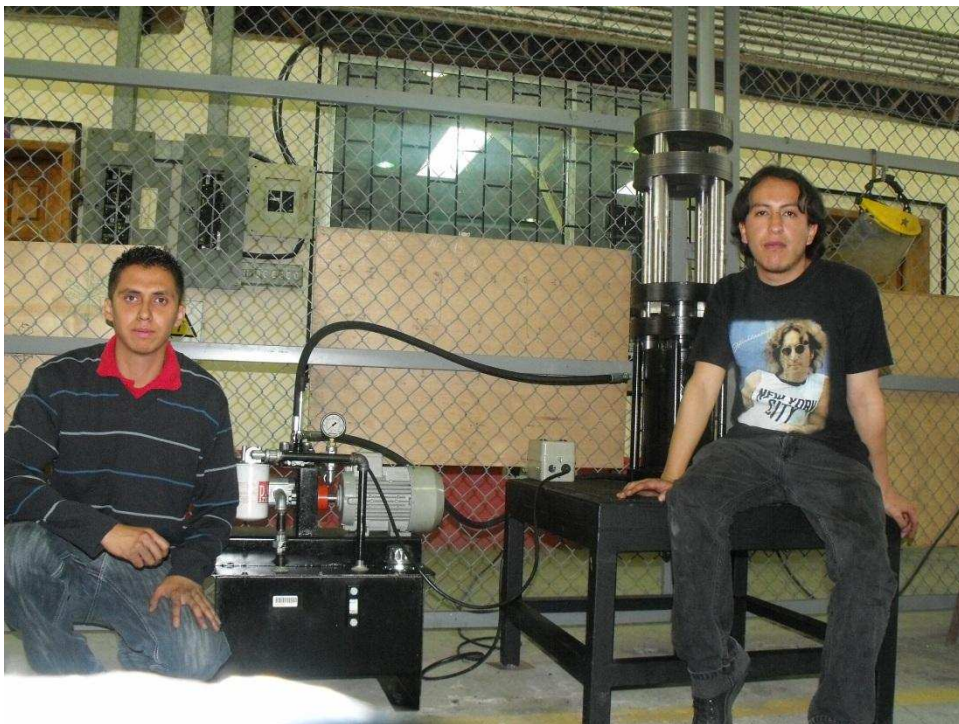
Figura 5-14: Máquina de ensayos destructivos en juntas soldadas y su sistema hidráulico (ensamble final) 4
