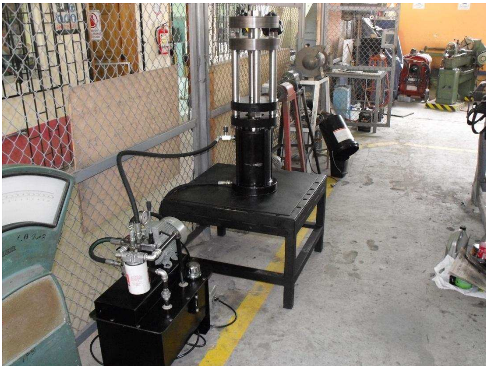
Figura 5-12: Máquina de ensayos destructivos en juntas soldadas y su sistema hidráulico (ensamble final) 3
