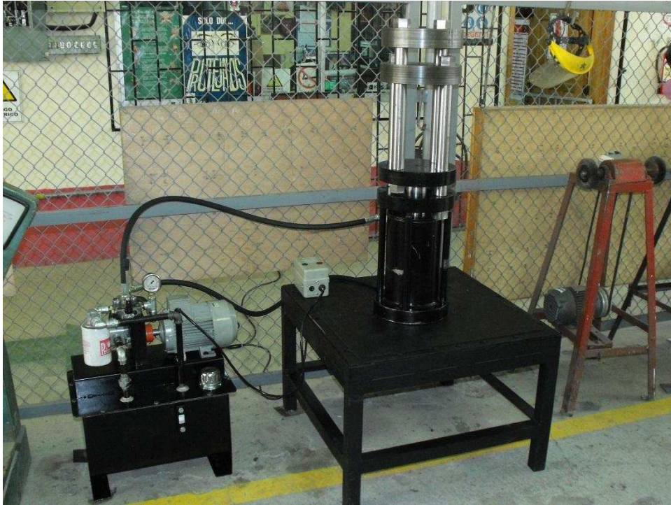
Figura 5-11: Máquina de ensayos destructivos en juntas soldadas y su sistema hidráulico (ensamble final) 2
