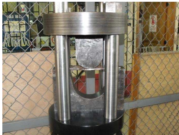
Figura 6-5: Montaje de los jig de doblado y probeta para el ensayo de doblado
