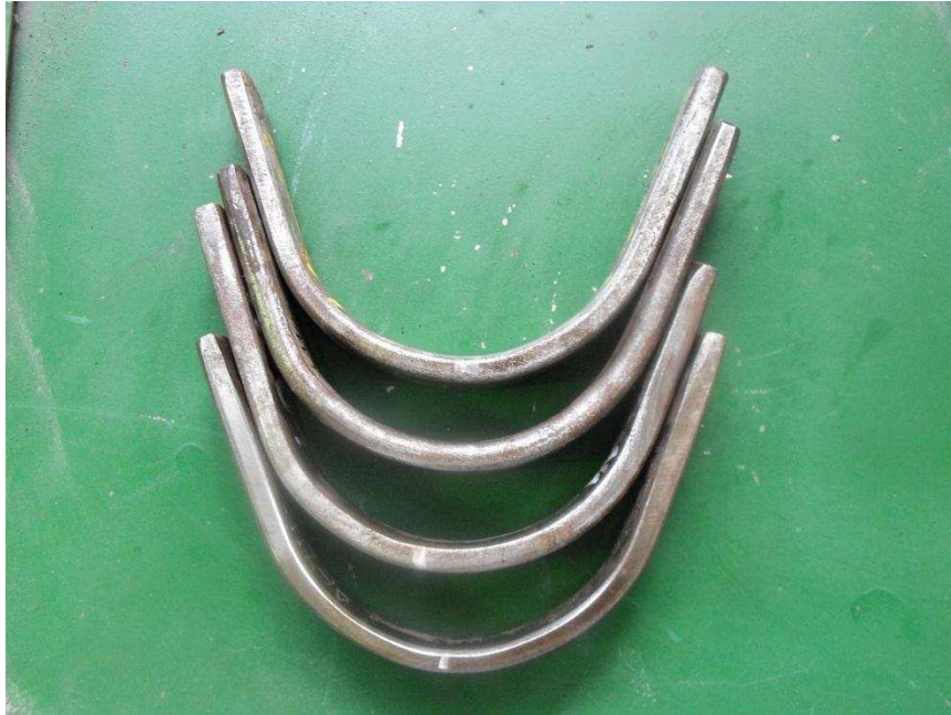
Figura 5-20: Probetas dobladas en la máquina
