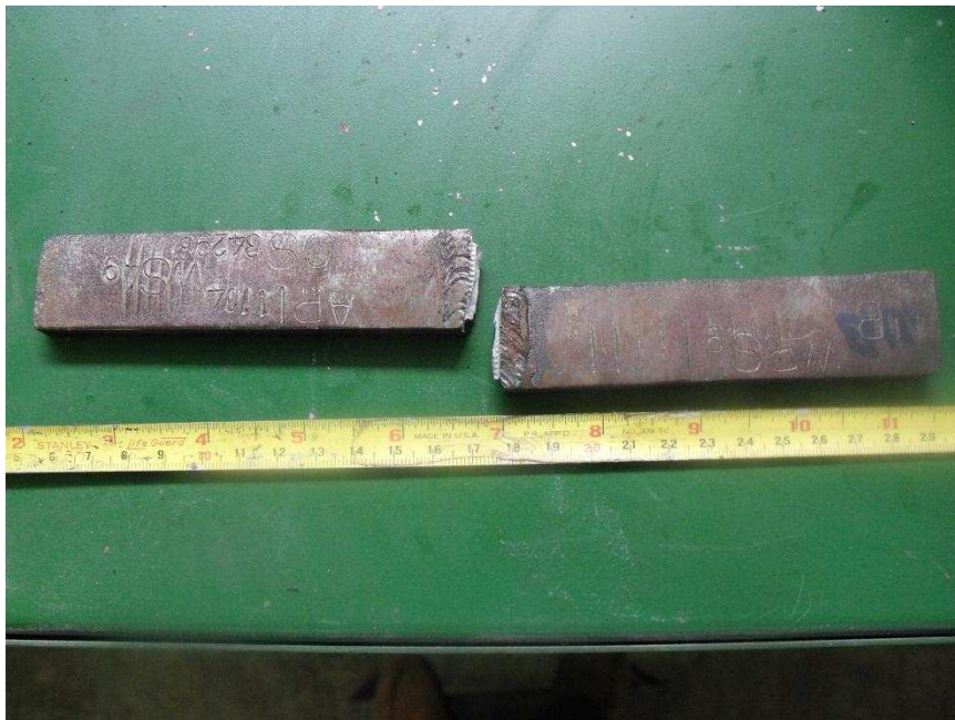
Figura 5-21: Probeta rota debido al ensayo de tracción realizado en la máquina
