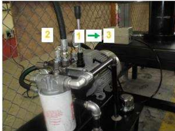
Figura 6-20: Palanca de mando en posición 3 para el regreso del pistón
