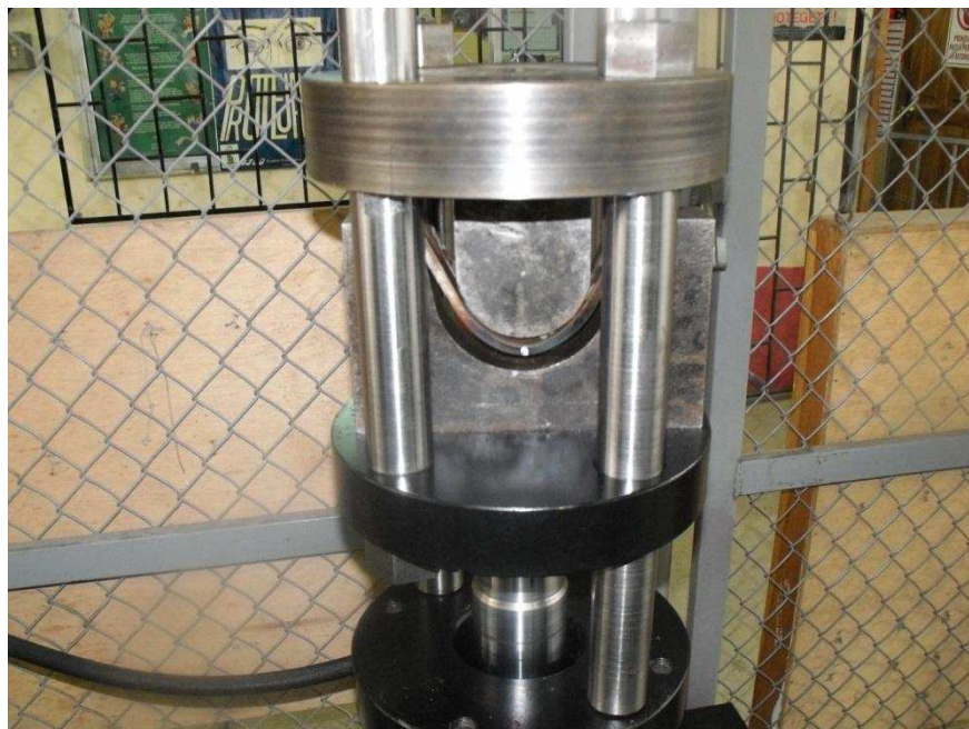
Figura 5-17: Ensayo de doblado en la máquina toma cercana
