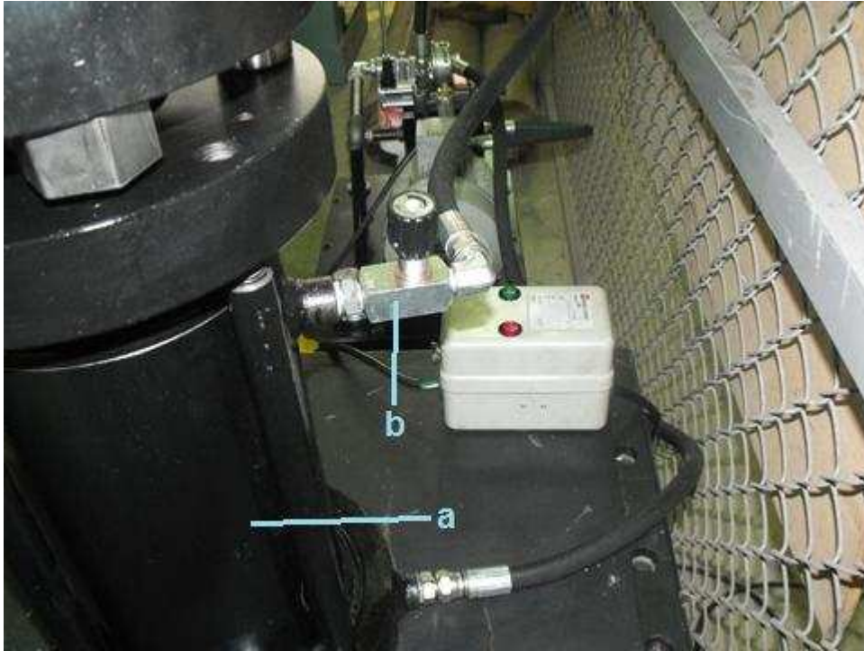
Figura 5-13: a) Cilindro hidráulico de doble efecto; b) Válvula estranguladora (reguladora de caudal)
