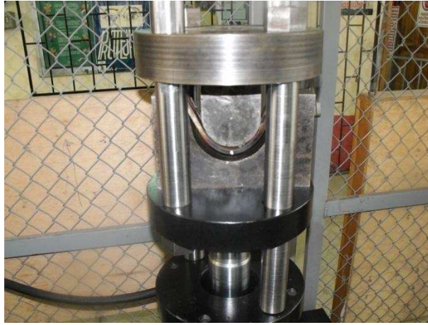
Figura 6-8: Culminación del ensayo de doblado
