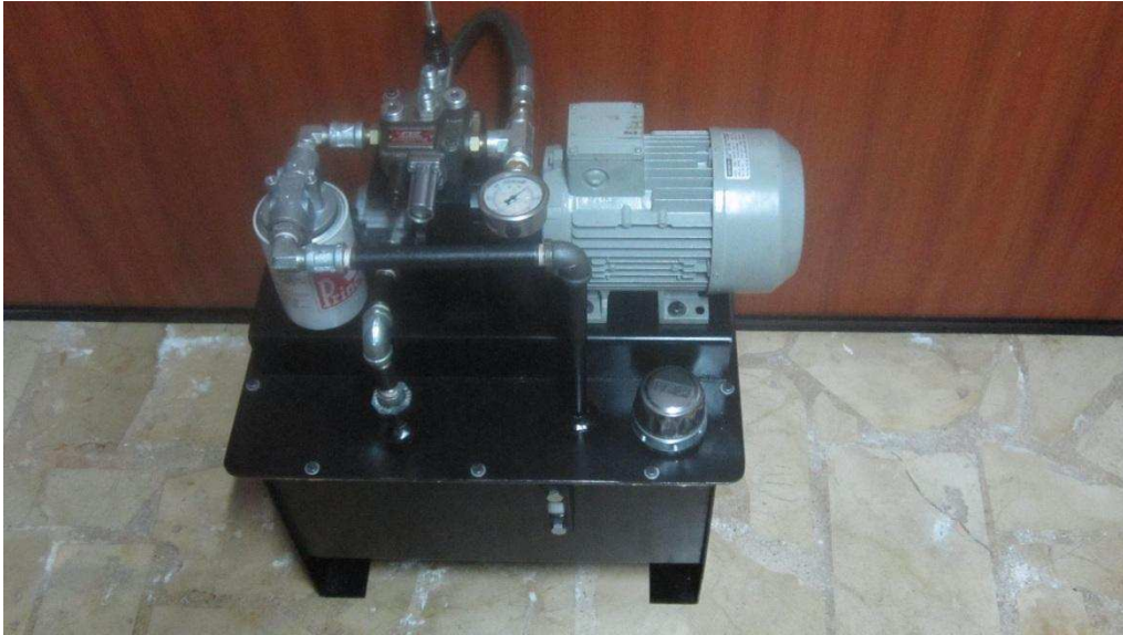
Figura 5-1: Unidad hidráulica pre-ensamblada 1
