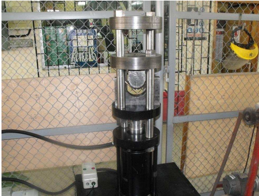
Figura 5-16: Ensayo de doblado en la máquina toma lejana
