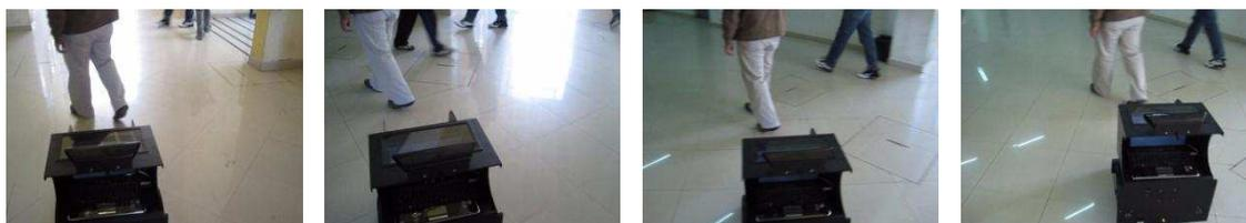
**Figura 4. 42** Ejemplo de seguimiento en una trayectoria curva izquierda
