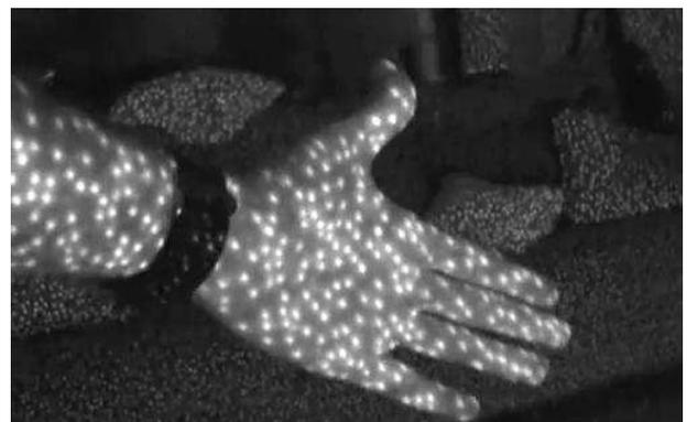
**Figura 1. 16** Fotografías con cámaras de visión nocturna de la proyección del patrón infrarrojo, que es invisible a la visión humana, tomado de [27]
