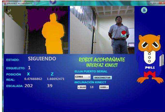
**Figura 4. 5** Captura de interfaz, con datos de posición del usuario, en los dos sistemas de coordenadas
