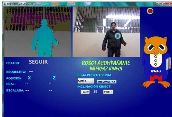
**Figura 3. 23** Programa para KINECT donde Imagen de profundidad se muestra personas azules en estado de seguimiento en espera.
