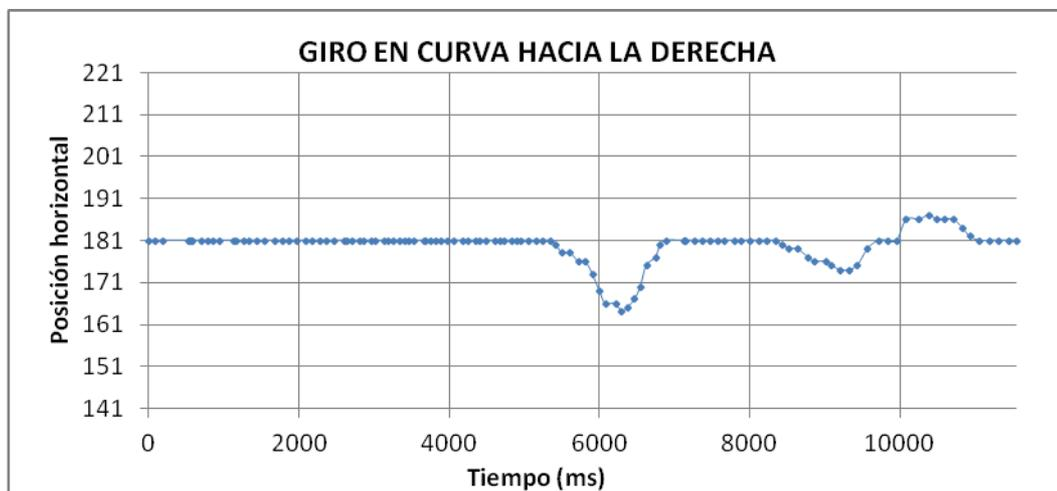
**Figura 4. 38** Comportamiento en giro del prototipo, durante seguimiento en trayectoria curva a la derecha
