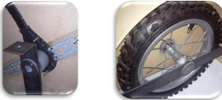
**Figura 2. 7** Sistema de acople y montaje de llantas
