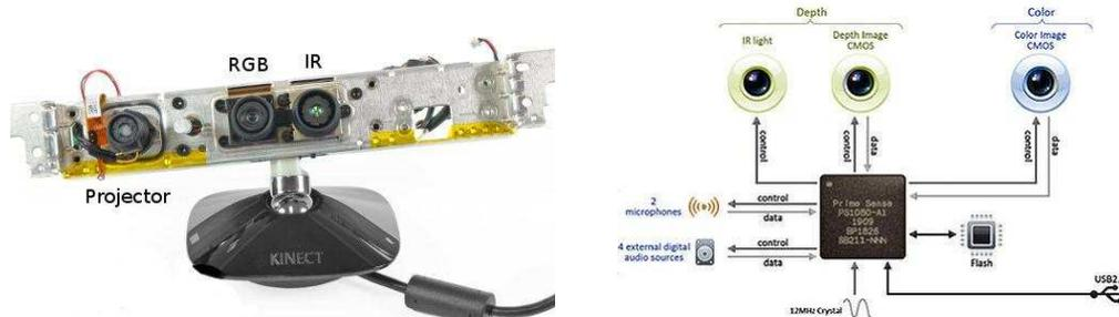
**Figura 1. 14** Distribución y relación de los elementos del KINECT, tomado de [25]
