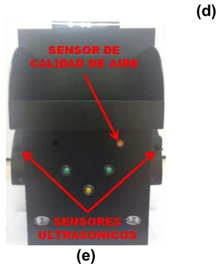
**Figura 2. 8** Montaje de elementos eléctricos y electrónicos
