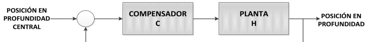
El compensador inicial que la herramienta SISO Design sugiere al colocar las restricciones de diseño fue manipulado hasta que se cumplan las especificaciones, obteniendo el modelo:
