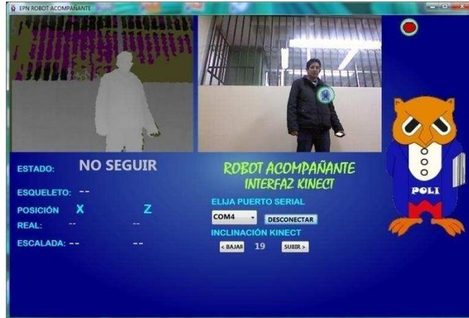
**Figura 3. 22** Programa para KINECT donde Imagen de profundidad se muestra en escala de grises en estados de no seguimiento.
