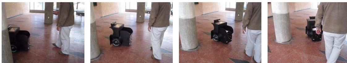
**Figura 4. 41** Ejemplo de seguimiento en una trayectoria curva derecha
