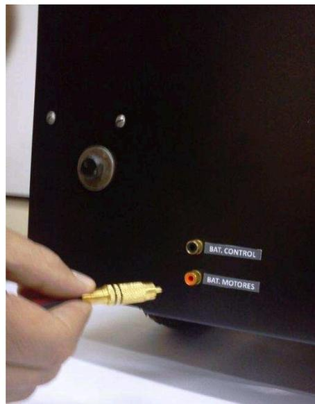
**Figura A.9** Conexión de cargador de baterías.
