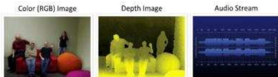
**Figura 1. 18** Tipos de datos entregados por el sensor, tomado de [20]
