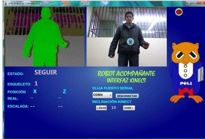
**Figura 3. 24** Programa para KINECT donde la imagen de profundidad muestra al usuario en verde en estado de seguimiento listo
