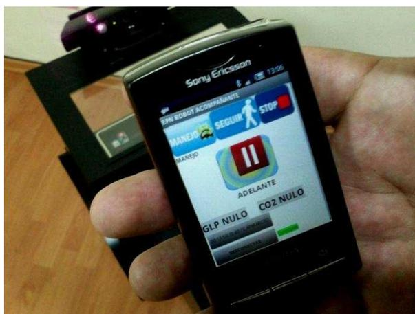
**Figura A.14** Mando virtual para manejo en las 4 direcciones.
