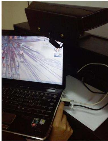
**Figura A.6** Conexión USB sensor KINECT
