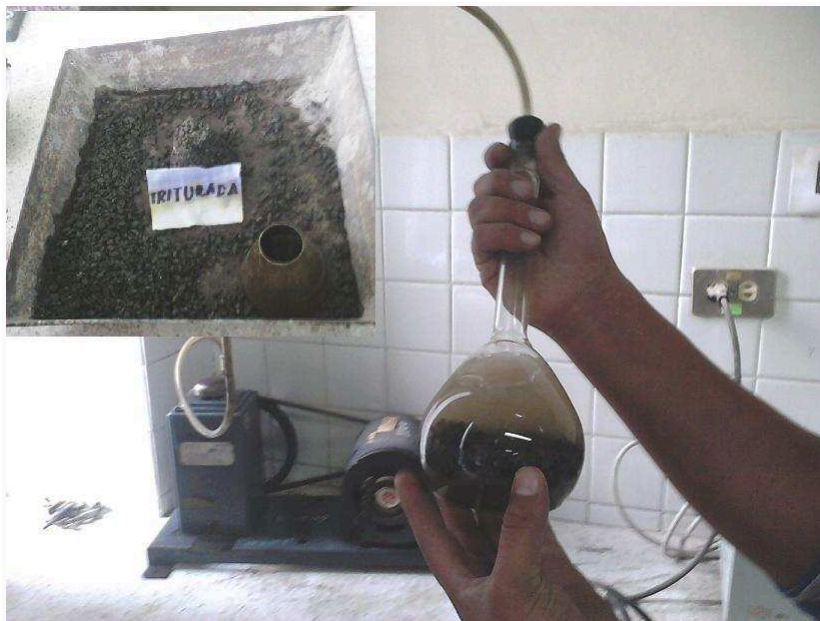
Fotografía 2.4. Ensayo de peso específico y absorción para arena
