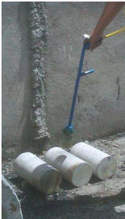
Fotografía 3.6. Exposición a propano incinerado de las probetas
