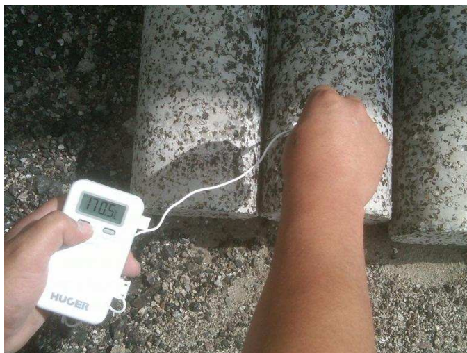
Fotografía 3.7. Control de temperatura durante el ensayo
