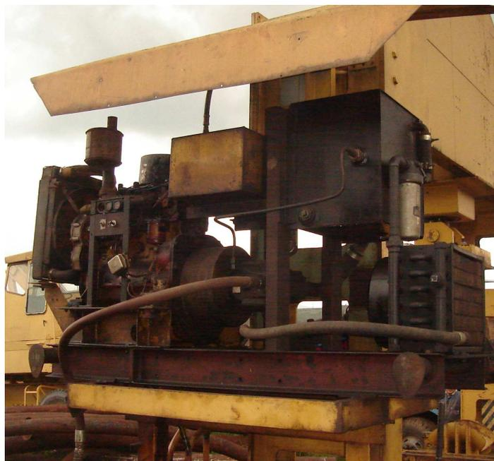
**FOTOGRAFIA No 1:** Conjunto Motor – Bomba – Radiador
