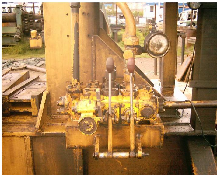
**FOTOGRAFÍA No. 3:** Mando del sistema hidráulico
