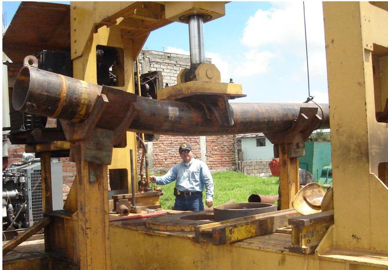
**FOTOGRAFÍA No 10:** Doblado de tubería de 12 pulgadas XS
