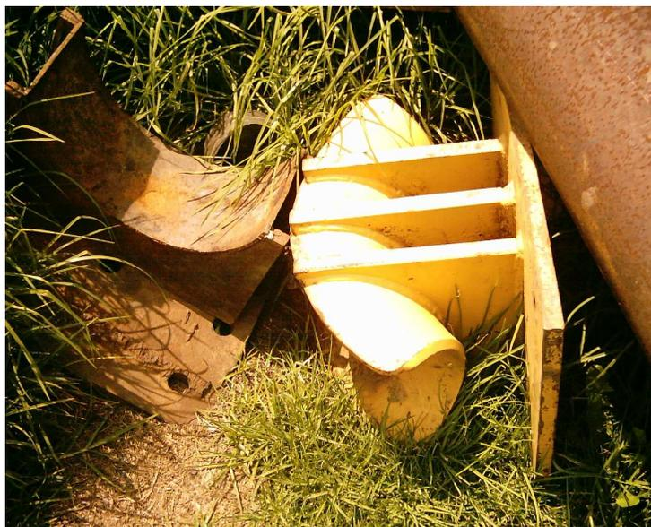
**FOTOGRAFÍA No. 4:** Matriz de doblado (tubería de 6 pulgadas)
