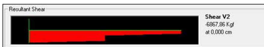
Figura 5.55 Cortante máximo en la conexión 3
