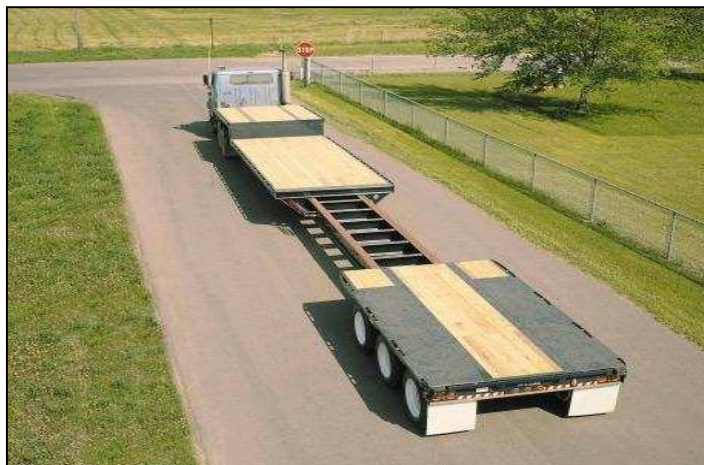
Figura 4.2 Semirremolque con soporte central de doble viga 46
