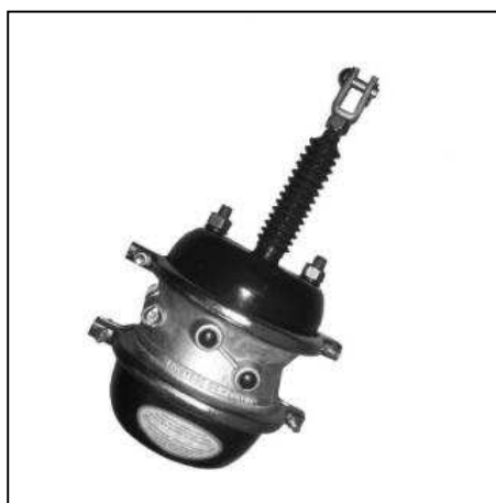
Figura 2.15 Cámara de aire 18
