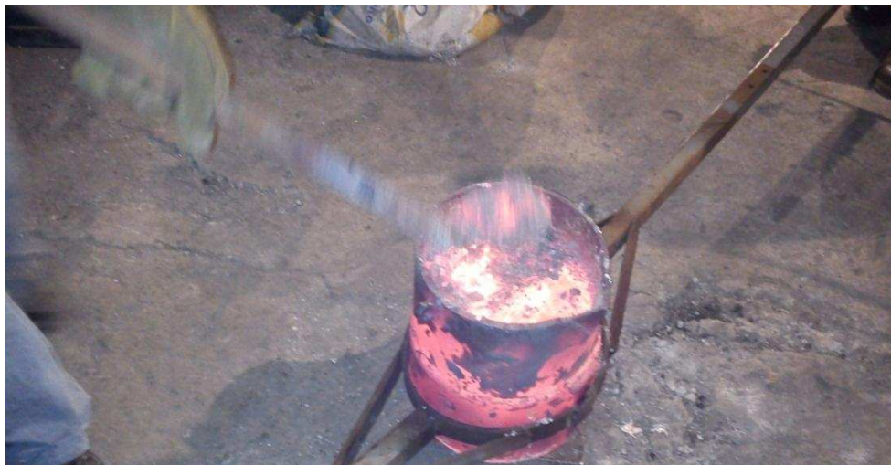
Imagen 21. Retirado de la escoria formada sobre el metal fundido.
