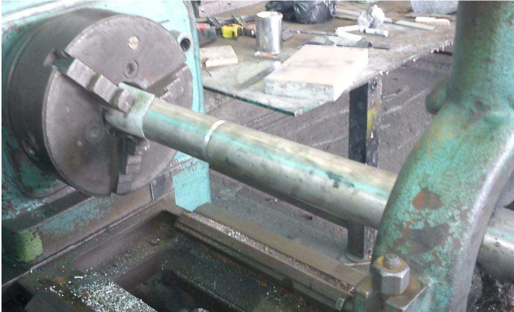
Imagen 28. Montaje sobre el mandril del torno con ayuna de una luneta.
