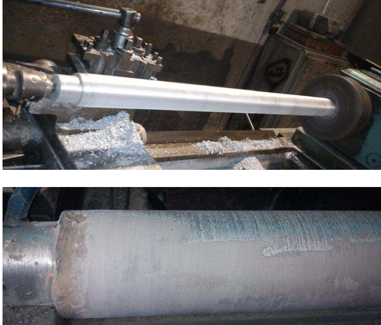
Imagen 2. Proceso de torneado y rectificación de modelos.
