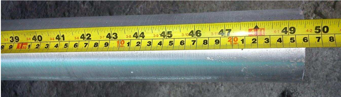
Imagen 26. Comprobación de medidas en la parte 1 de la antena que debe ser 1250mm; tiene 6mm de sobredimensionamiento en su longitud.
