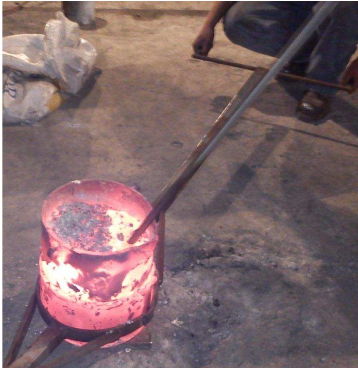
Imagen 20. Insuflado de argón en el crisol con metal fundido mediante lanza de acero inoxidable.
