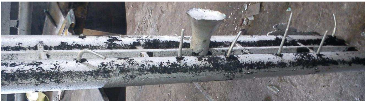
Imagen 24. Pieza de aluminio obtenida con sistema de alimentación y respiraderos.
