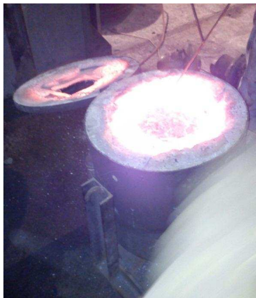
Imagen 19. Adición de fundentes y desgasificantes con el horno apagado.
