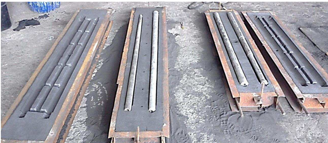
Imagen 15. Moldes de arena verde terminados.
