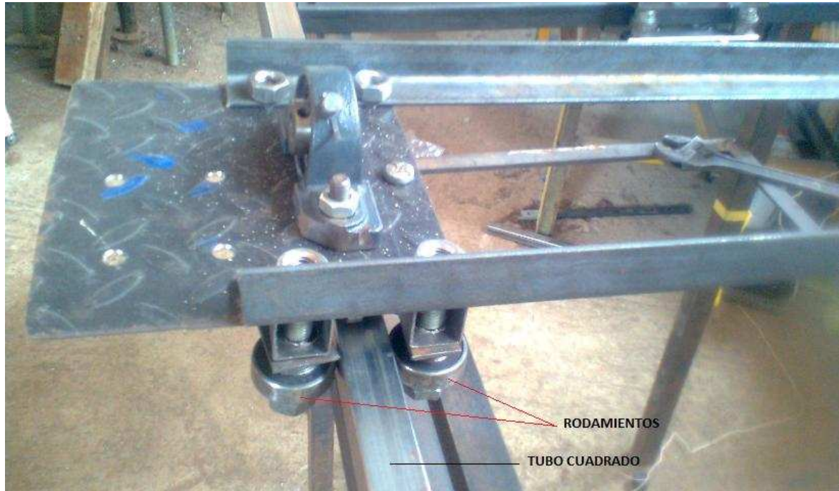
Figura 4.4 Sistema móvil de tubo cuadrado con rodamientos
