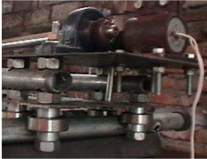
Figura 3.19 Falta de sujeción entre guías y rodamientos (tercer prototipo mecánico)
