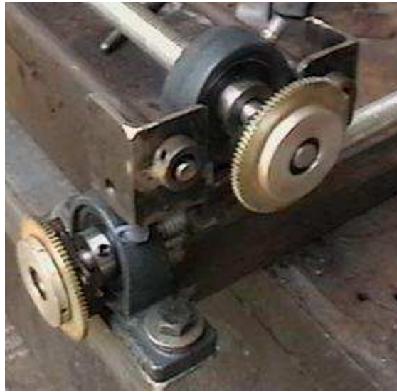
Figura 3.9 Acoplamiento de piñones en extremos de tornillos sin fin (primer prototipo mecánico)
