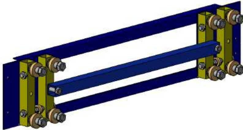
Figura 3.27 Incorporación del eje transversal
