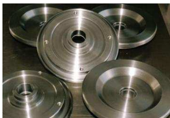
Figura 1.9 Piezas realizadas por una fresadora
