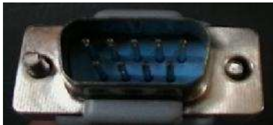
Figura A-6 Cable DB9, conexión a caja de control
