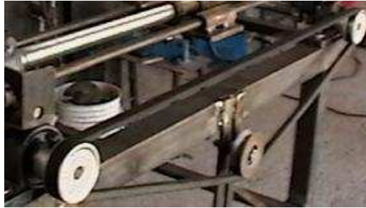
Figura 3.11 Transmisión de movimiento entre tornillos sin fin del eje longitudinal (primer prototipo mecánico)
