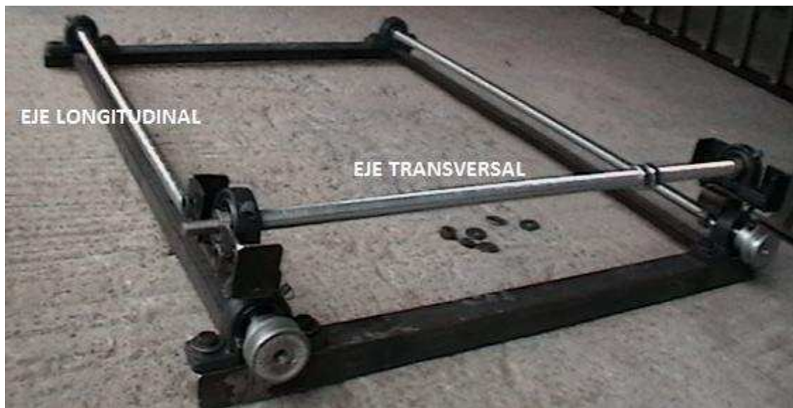
Figura 3.10 Ejes longitudinal y transversal (primer prototipo mecánico)
