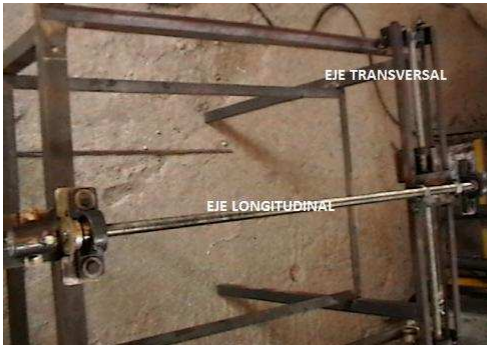
Figura 3.13 Eje longitudinal y transversal (segundo prototipo mecánico)
