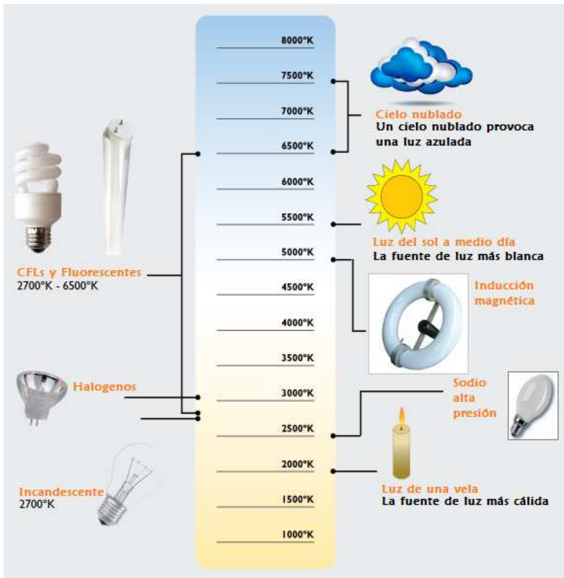
Fig. 6.6. Temperatura del color de diferentes fuentes luminosas
