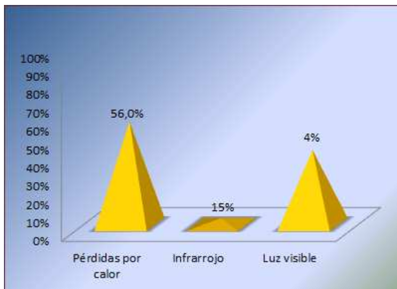
Fig. 4.10. Balance energético de una lámpara de sodio a alta presión
