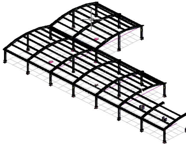
**Figura 4. 16.-** Esquema de ampliación de los pórticos.
