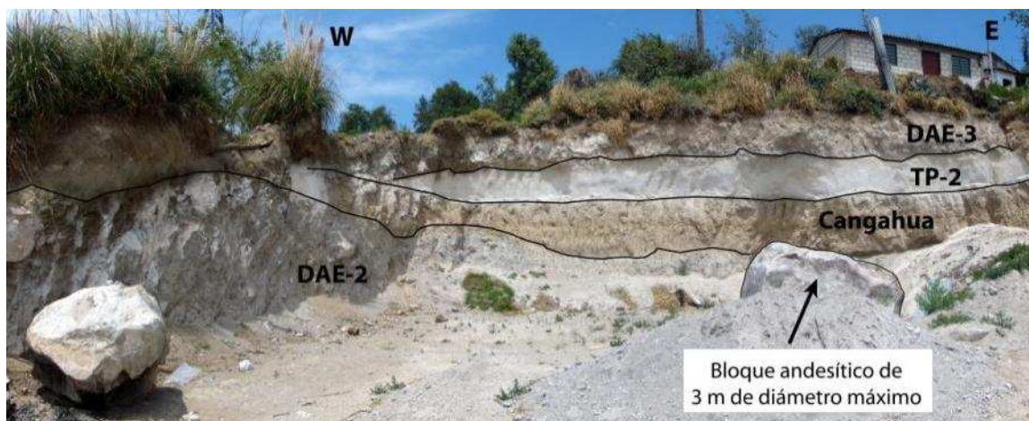
Figura 4.24. Afloramiento del DAE-2 en Totoras (UTM: 767550, 9855310). Se observa que una capa de Cangahua de 0,5 a 1,5 m de espesor cubre el DAE-2. Notar los dos bloques andesíticos masivos, ambos tienen alrededor de 3 m de tamaño.
