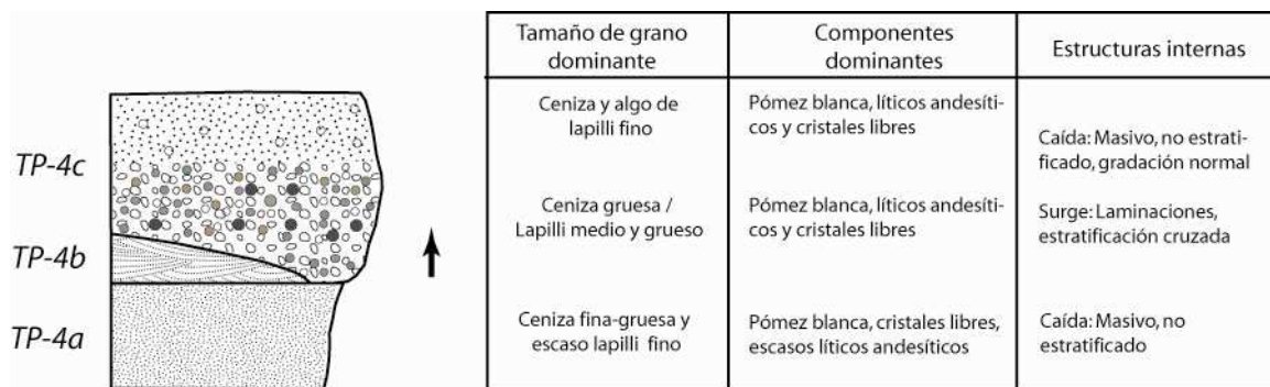
Figura 4.37. Litoestratigrafía esquemática de la tefra TP-4. Izquierda: estratigrafía interna esquemática del depósito. Derecha: principales características litológicas. La flecha negra representa la variación de la gradación interna del tamaño de grano.
