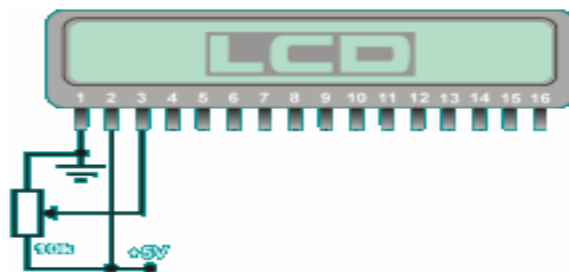
FIG 1.25. Distribución de pines del LCD 13
