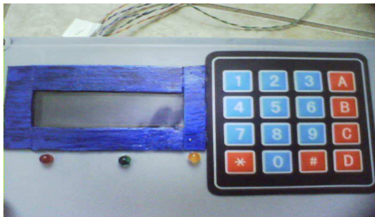
FIG 2.11: LCD, teclado y leds indicativos en la parte frontal de la caja.
