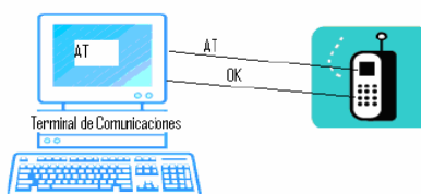
FIGURA 1.5: Esquema de comunicación entre un computador y un celular 5
