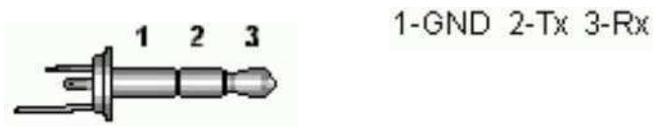
FIG 1.33: Distribución de pines del conector (Jack) a través del cual intercambian datos el PIC y el celular 16 .
