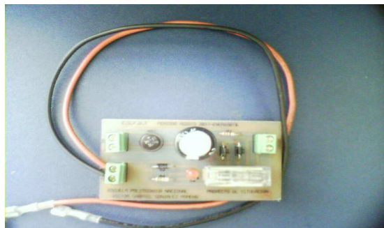
FIG 2.6: Fuente con sus elementos terminada
