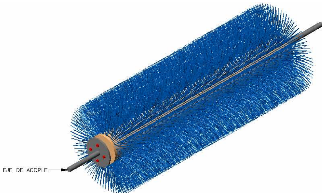
Figura 4.24 Esquema CEPILLO – EJE DE ACOPLA
