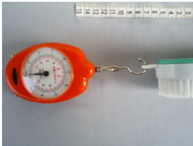
Figura 4.10 Cepillo con el dinamómetro
